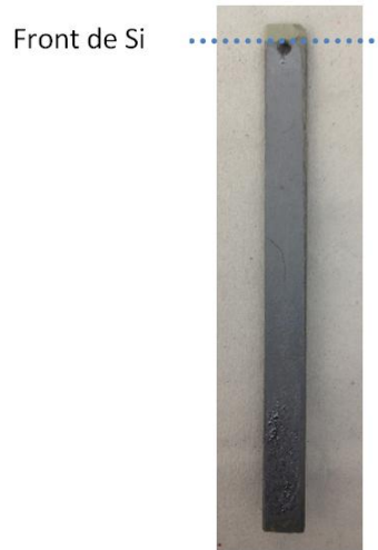
Figure 174. Front d'imprégnation du silicium au sein d'un compact de poudre MT59
