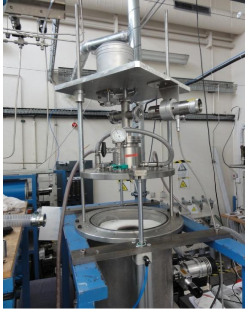
Figure 63. Ouverture du four par translation de la partie haute du montage
