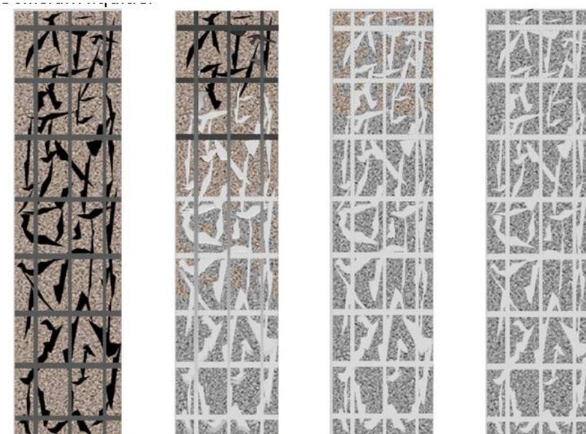
Figure 197. Mécanisme 2 : progression par les fissures puis alimentation des blocs de poudre
