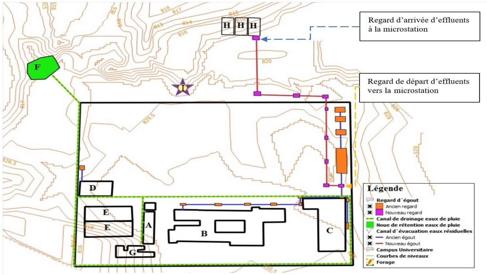
Figure 37. Croquis du possible emplacement de l'installation de la station de Campus de l'UNIKIVI – Uge
