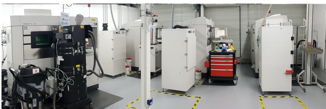
FIGURE 1 – Photo d'une partie de la salle de production du procédé de fabrication DMLS au sein de l'entreprise INITIAL.
