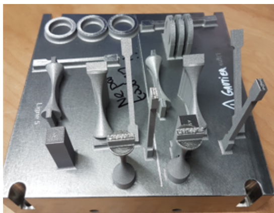
FIGURE 3.11 – Plateforme élaborée dans le cadre du plan d'expériences composée des éprouvettes de traction, de fatigue et des blocs métallographiques.
