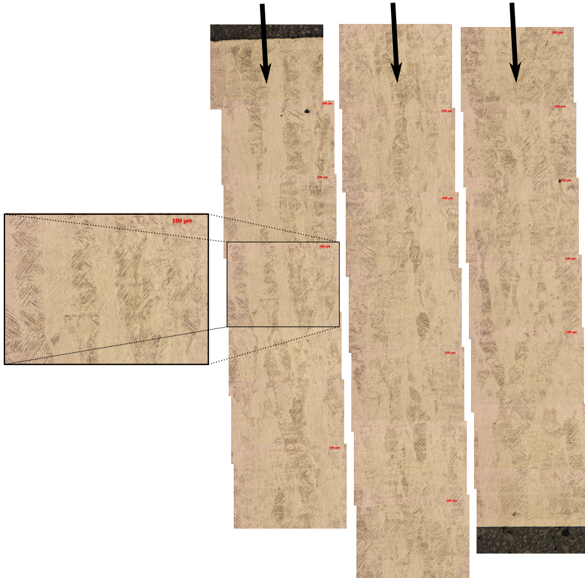
FIGURE 3.7 – Reconstruction par la superposition de 21 images en microscopie optique de la zone centrale (L 2 ) d'un bloc métallographique brut d'élaboration en vue d'observer un éventuel impact de l'arrêt de production.
