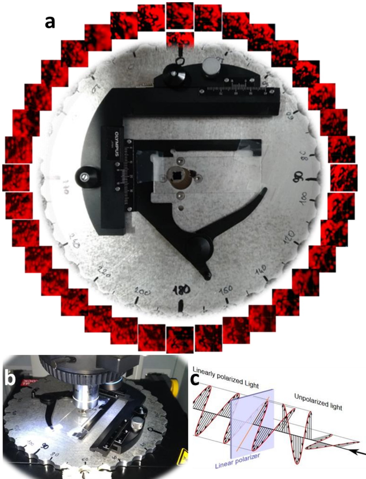
Figure IV- 21 Photographies du plateau tournant a) Avec les 36 (+1) cartographies mesurées. b) En condition de mesure. c) Schéma du champ électrique associé à de la lumière polarisée linéairement. Adapté de la réf. 82
