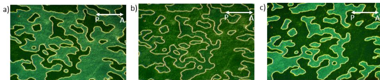
Figure 2-28 Domaines de torsion gauche et droite dans une cellule twistée à 90° P6/PVA. La couche P6 a été obtenue avec un temps d'insolation UV de 20min. La température de l'échantillon est égale à 110°C. Les trois photos montrent le même échantillon avec différents angles d'orientation par rapport au polariseur qui permettent d'obtenir : (a) l'extinction des domaines gauches (b) même intensité des deux types de domaines, (c) l'extinction des domaines droits.
