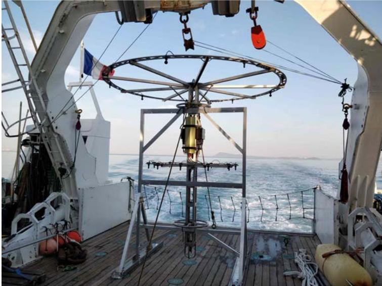
**FIGURE 3.10** – Photographie de l'antenne finale construite sur le pont arrière du navire *L'Europe*. Elle est composée de 17 hydrophones HTI-96-MIN et de 4 hydrophones Neptune D/60. (Crédits : OSEAN SAS)
