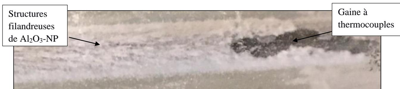
*Figure 52. Cliché de la poudre  $Al_2O_3$ -NP séchée en contact avec la gaine en Inox. Observation d'un « hérissage » des particules.*
