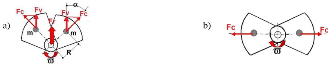
Figure 40. Configuration des balourds : a) mode vibration circulaire, b) mode sans vibration (situation d'équilibre).
