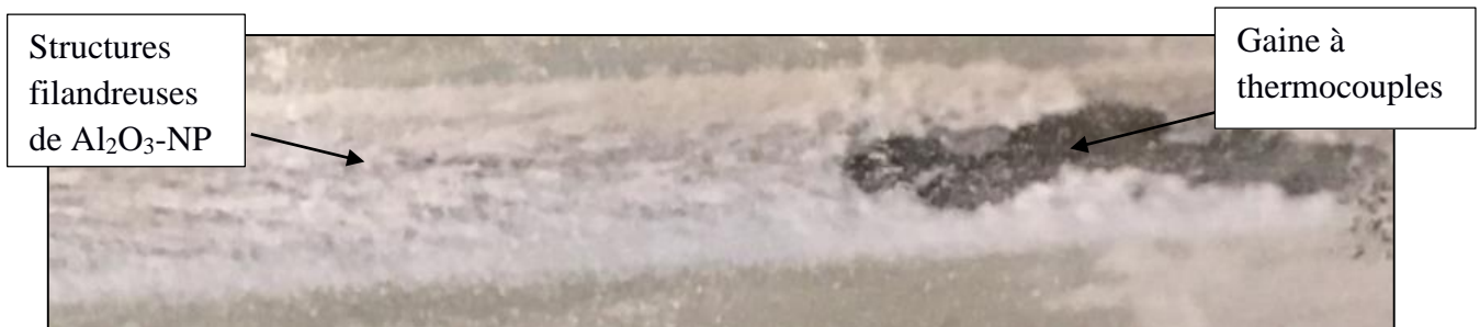
Figure 52. Cliché de la poudre \text{Al}_2\text{O}_3\text{-NP} séchée en contact avec la gaine en Inox. Observation d'un « hérissage » des particules.
