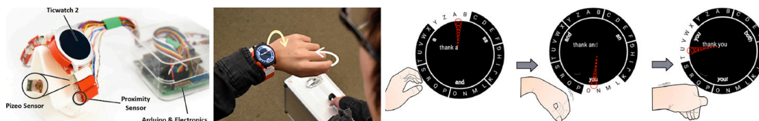
Figure 3.32: WrisText . Clavier circulaire basé sur l'inclinaison du poignet. Illustration extraite de (Gong et al. , 2018).
