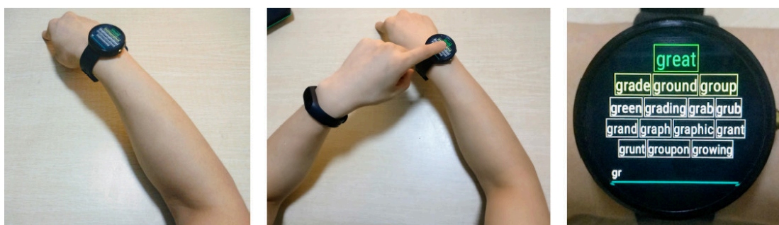
Figure 3.33: SHOW ( Smart Handwriting On Watches ). Écriture manuscrite sur n'importe quelle surface horizontale. Illustration extraite de (Lin et al. , 2018).
