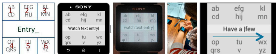
Figure 3.6: Clavier virtuel alphabétique avec suggestion des mots. Illustration extraite de (Komninos et Dunlop, 2014).
