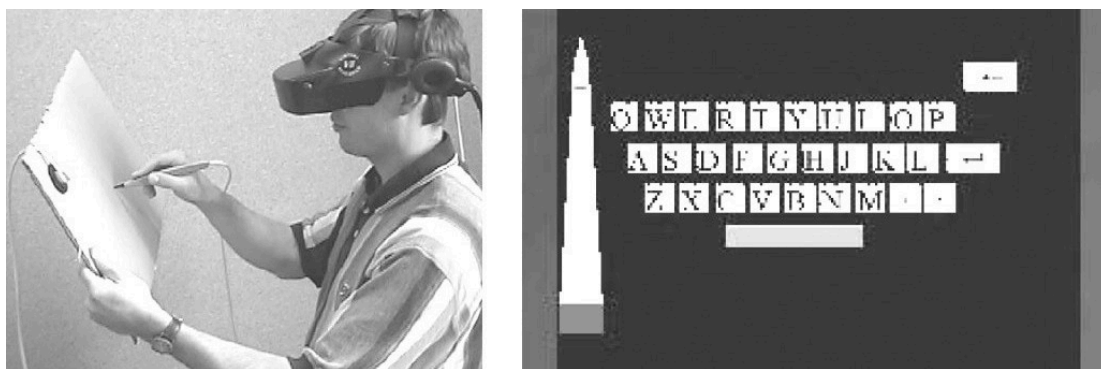
Figure 2.54: Utilisation du stylet et d'une tablette avec un clavier virtuel. Illustration extraite de (Bowman et al. , 2002).
