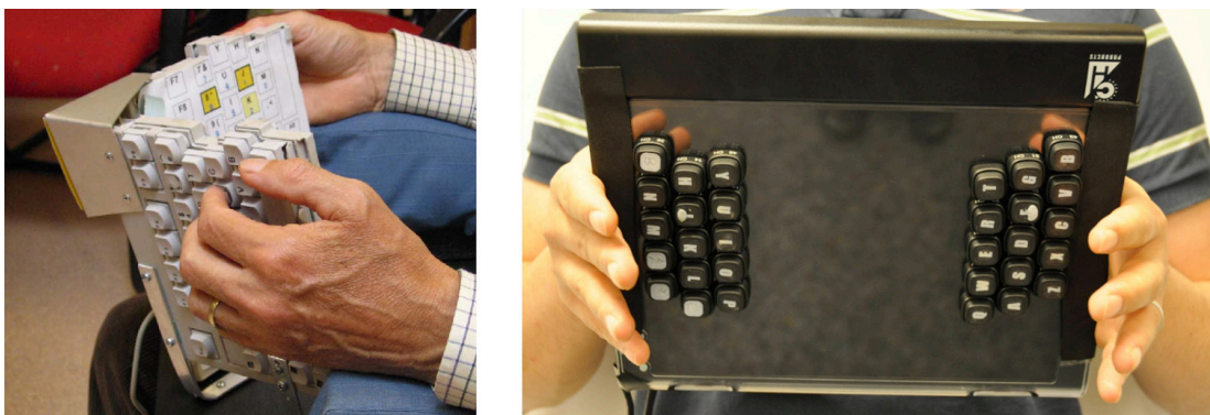
Figure 4.26: Clavier vertical (gauche) et RearType , clavier à l'arrière d'une tablette (droite). Illustrations extraites de (Van Galen et al. , 2007; Scott et al. , 2010)
