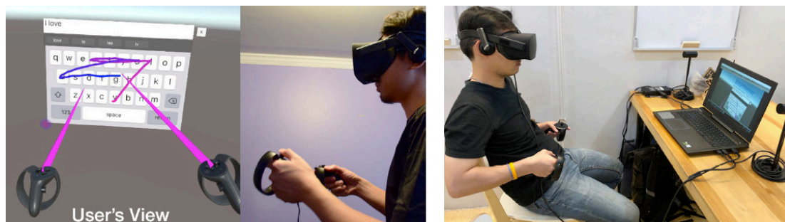
Figure 2.30: Technique de Pointeur par manette avec la saisie de mots par gestuelle. Illustration extraite de (Chen et al. , 2019).
