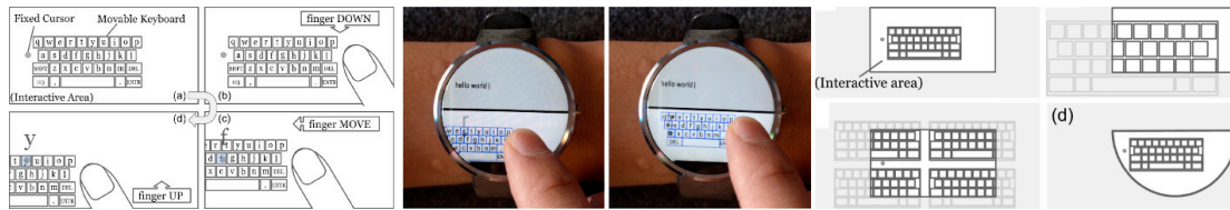
Figure 3.19: DriftBoard . Déplacer le clavier virtuel sous un curseur fixe pour saisir des caractères. Illustration extraite de (Shibata et al. , 2016).
