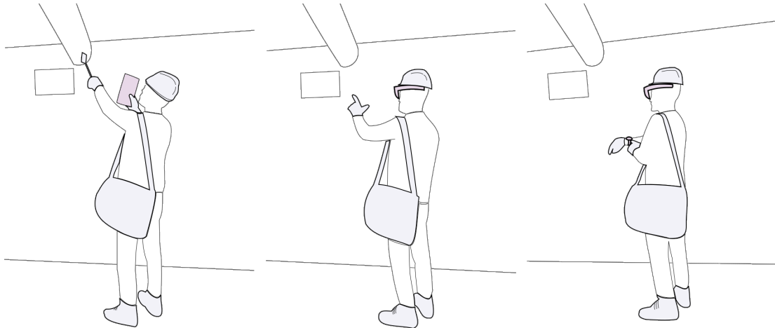
Figure 3.41: Utilisation de la tablette, du visiocasque de réalité augmentée et de la montre connectée pour l'inspection de traversées.
