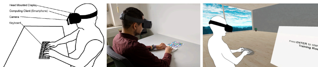
Figure 2.21: Configuration simple et mobile en utilisant un clavier traditionnel sans fil avec un visiocasque à base de téléphone intelligent. Illustration extraite de (Knierim et al. , 2020).
