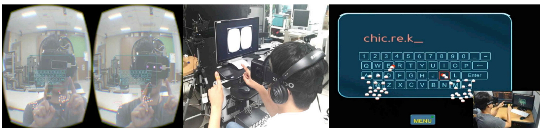
Figure 2.5: Utilisation d’un dispositif complémentaire de reconnaissance des mouvements. Illustration extraite de (Kwon et al. , 2016).
