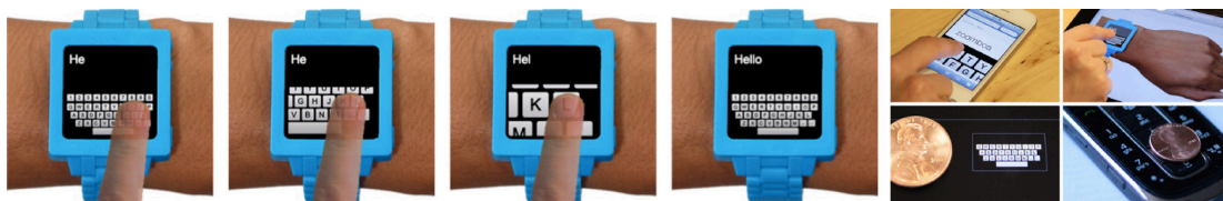
Figure 3.5: ZoomBoard . Agrandissement de la disposition du clavier virtuel. Illustration extraite de (Oney et al. , 2013).
