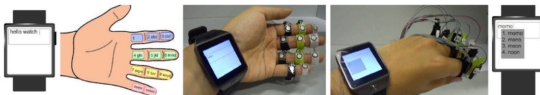
Figure 3.26: FingerT9 . Ensemble de capteurs portés entre les articulations des doigts. Illustration extraite de (Wong et al. , 2018).
