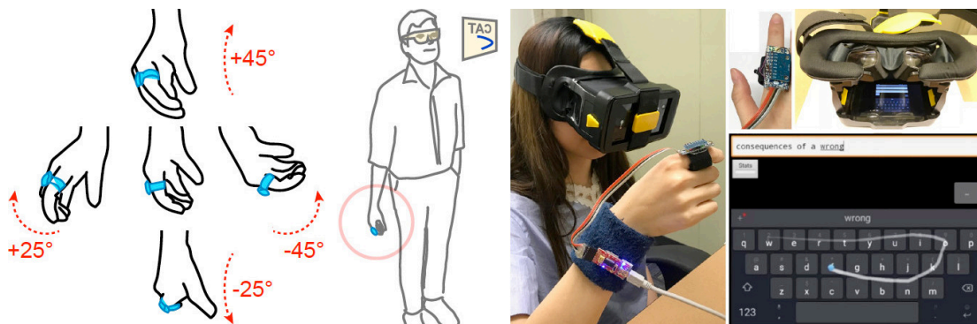
Figure 2.50: RotoSwype . Anneau équipé d'une centrale inertiel et d'un bouton pour saisir des mots par gestuelle. Illustration extraite de (Gupta et al. , 2019).
