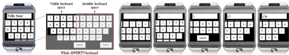
Figure 3.17: Virtual Sliding QWERTY (VSK) . Naviguer à travers le clavier virtuel. Illustration extraite de (Cha et al. , 2015).
