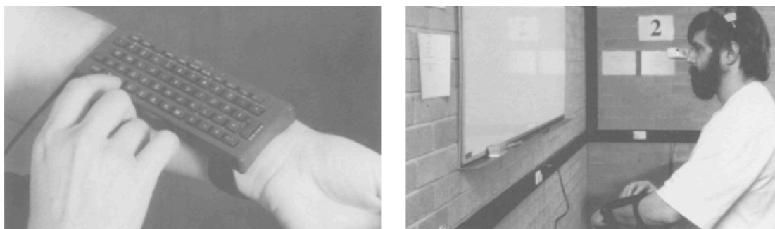
Figure 2.22: Clavier porté sur l'avant-bras. Illustration extraite de (Thomas et al. , 1998).
