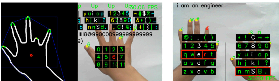
Figure 2.4: Air Typing . Disposition monomanuel et bimanuel du clavier virtuel. Illustration extraite de (Chang et al. , 2014).
