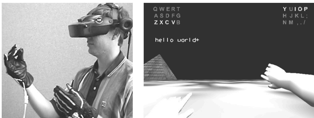
Figure 2.36: Pinch Keyboard . Paire de gants avec points de contact placés au bout des doigts. Illustration extraite de (Bowman et al. , 2002).
