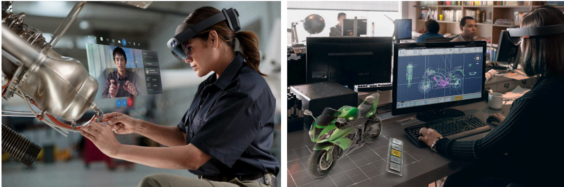
Figure 1.1: Exemples d'utilisation d'un visiocasque de réalité augmentée dans des environnements de type industriel et de bureau. À gauche, une professionnelle accroupie utilise des outils pour réparer une machine, une fenêtre virtuelle flottante présente les conseils d'un expert. À droite, une professionnelle conçoit les plans d'une moto sur un ordinateur personnel puis manipule un rendu virtuel tridimensionnel ancré sur le bureau d'un espace partagé. Illustrations extraites des campagnes promotionnelles de l'HoloLens (1 er et 2 e génération) de Microsoft.
