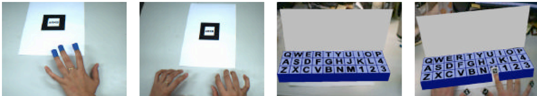
Figure 2.3: ARKB . Marqueur de couleur sur le bout des doigts, marqueur fiduciale et clavier virtuel. Illustration extraite de (Lee et Woo, 2003).
