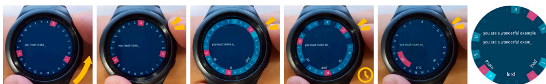
Figure 3.25: COMPASS . Utilisation (rotation) d’un anneau circulaire tangible. Illustration extraite de (Yi et al. , 2017).
