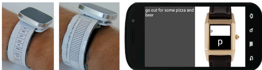
Figure 3.24: Interfaces de saisie de texte pour montre connectée basées sur un bracelet tactile. Illustration extraite de (Funk et al. , 2014).
