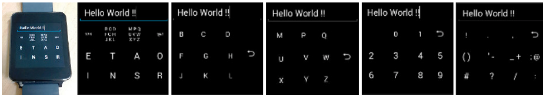
Figure 3.10: ETAO . Disposition des lettres suivant leur fréquence dans la langue anglaise. Illustration extraite de (Darbar et al. , 2016a).
