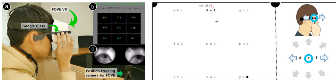
Figure 2.13: Interface multimodale entre le suivi oculaire et le geste tactile. Illustration extraite de (Ahn et Lee, 2019).
