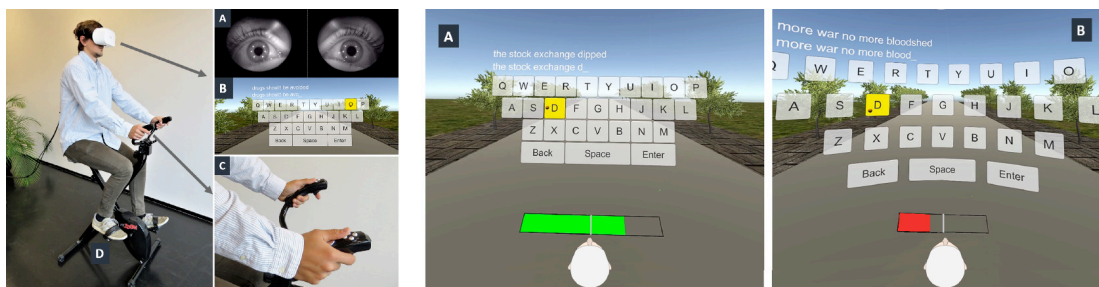
Figure 2.12: Gestuelle du regard avec clavier virtuel plat-condensé et courbé-étiré. Illustration extraite de (Rajanna et Hansen, 2018).
