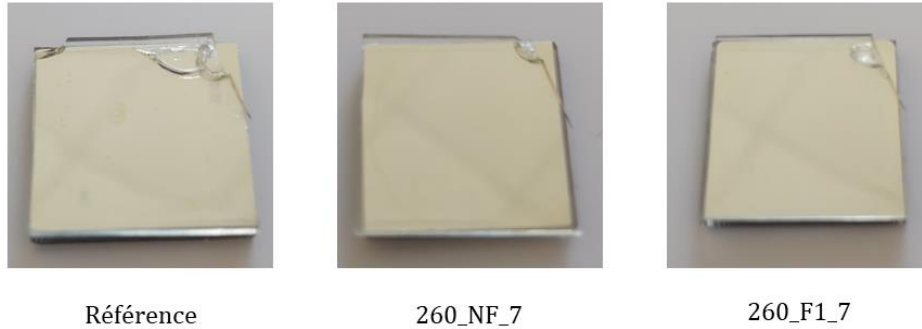
Figure III-3 : Clichés des échantillons posés sur des fenêtres en quartz munies d'une face miroir à leur remise à l'air libre après irradiation UV.
