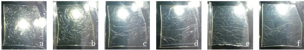
Figure II-21 : Clichés après irradiation d'échantillons contenant des nanoparticules fonctionnalisées : a) référence, b) 1 \mu\text{m} , c) 3 \mu\text{m} , d) 7 \mu\text{m} , e) 14 \mu\text{m} , f) 28 \mu\text{m} .
