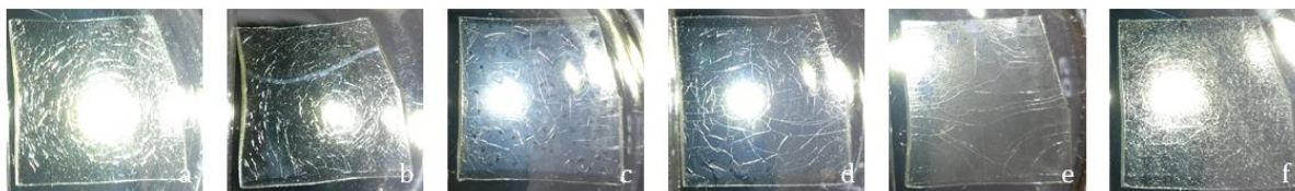
Figure II-14 : Clichés après irradiation d'échantillons contenant des nanoparticules non fonctionnalisées : a) référence, b) 1 \mu\text{m} , c) 3 \mu\text{m} , d) 7 \mu\text{m} , e) 14 \mu\text{m} , f) 28 \mu\text{m} .
