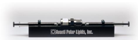
Figure 8 : Mini-Extruder d'Avanti Polar Lipids Inc., appareil de paillasse pour extruder les liposomes.
