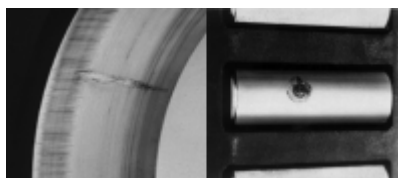
Figure 13 - Exemple d'endommagements liés à un passage de courant [7]
