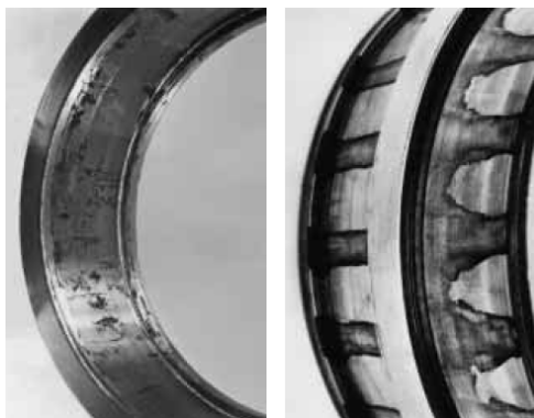
Figure 8 - Effet de la corrosion sur un roulement [7]
