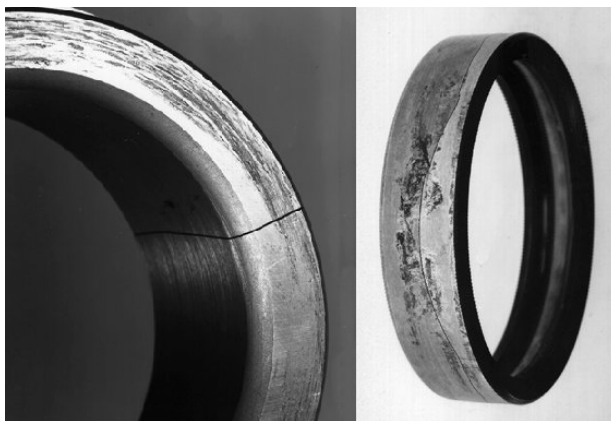
Figure 12 - Exemples de fissure [7]
