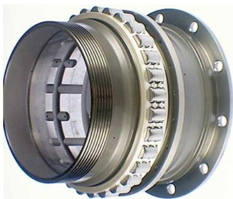
Figure 6 - Palier 4 d'un CFM56
