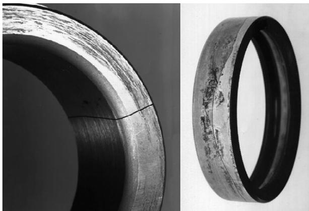
Figure 12 - Exemples de fissure [7]
