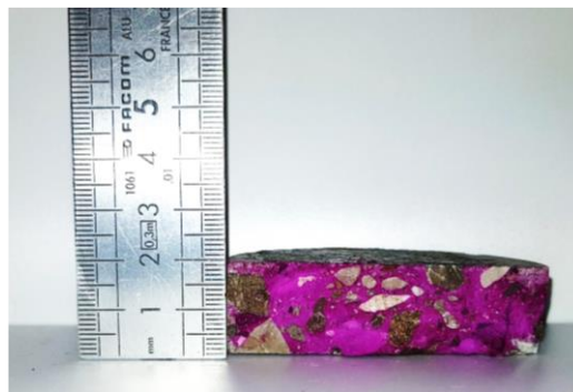
Figure II-17 : 2 ème tranche (profondeur : 2 cm à 4 cm) issue de la carotte ayant subi 28 jours de lixiviation, fendue puis enduite de phénolphtaléine
