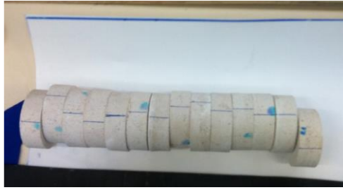
Figure IV-6 : a) 14 tranches d'un même cylindre de calcaire prélevé sur le 2 ème bloc ; b) imbibition de 1 cm d'eau sur la colonne de tranches réassemblées
