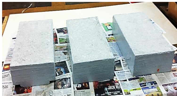
Figure II-4 : Photo des 3 éprouvettes de béton imperméabilisées (la partie latérale couverte par la résine est plus foncée) ; chaque surface orientée vers le haut sur la photo sera la surface attaquée chimiquement
