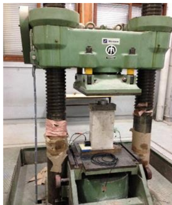
Figure V-2: Photo de la presse utilisée, avec une éprouvette instrumentée
