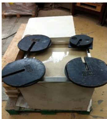
Figure IV-4 : Illustration du protocole expérimental sur le bloc calcaire (imbibition de 1cm d'eau sur la surface de calcaire étanchéifiée sur les côtés)
