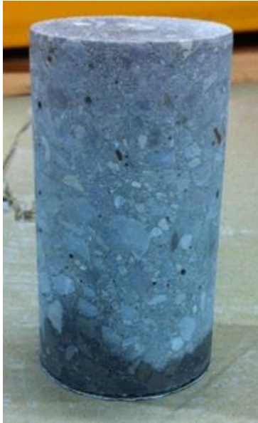
Figure II-7 : [gauche] Une carotte extraite après la première phase de dégradation ; [droite] la dalle carottée avec la réimperméabilisation de chaque zone carottée
