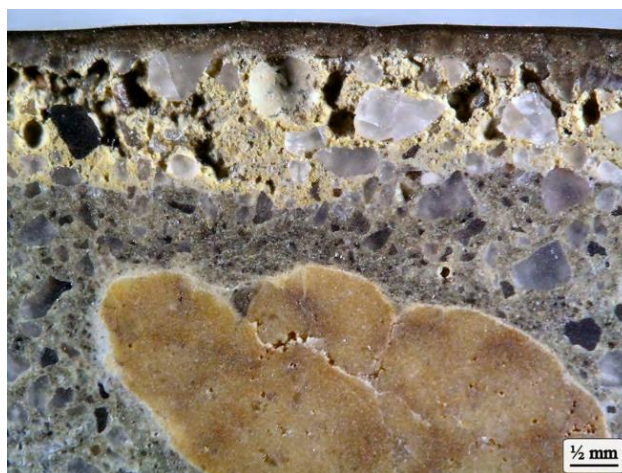
Figure I-2 : Vue en coupe sous microscope de l'attaque acide de la pâte cimentaire [Pabalan – 2011]
