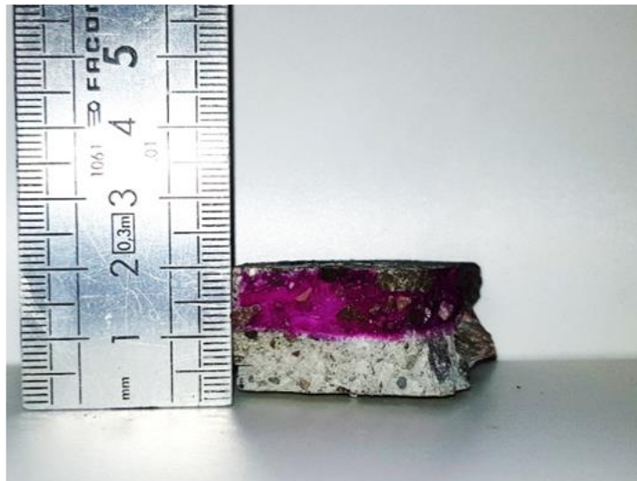
Figure II-9 : Photo d'une tranche fendue sur laquelle on a appliqué de la phénolphtaléine
