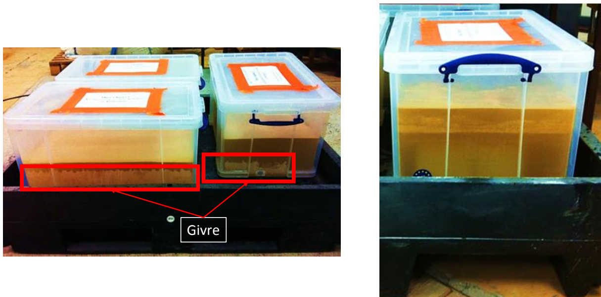
Figure II-6 : [gauche] Illustration de la réaction endothermique de dissolution du \text{NH}_4\text{NO}_3 (formation de givre) ; [droite] éprouvette de béton immergée dans la solution lixiviante
