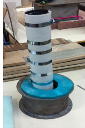
Figure IV-6 : a) 14 tranches d'un même cylindre de calcaire prélevé sur le 2 ème bloc ; b) imbibition de 1 cm d'eau sur la colonne de tranches réassemblées
