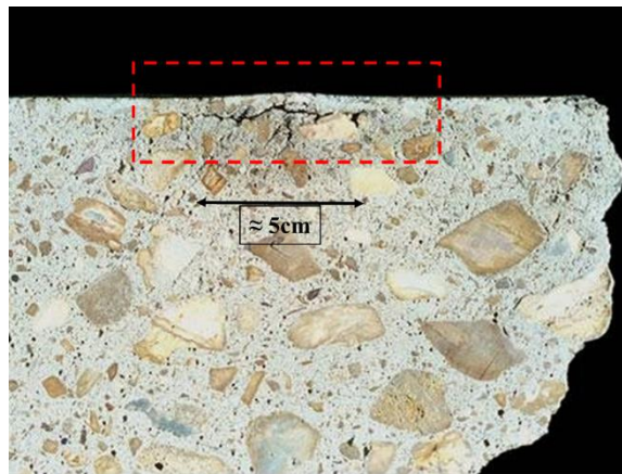
Figure III-1 : Vue en coupe d'une dalle délaminiée en surface
