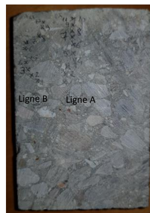
Figure II-14 : [gauche] Carotte extraite en fin d'étude avec indication de découpe ultérieure ; [milieu] schéma des 2 lignes de points d'indentation choisies [droite] sur la tranche issue de la découpe, tracé de 2 lignes d'une dizaine de points d'indentation chacune
