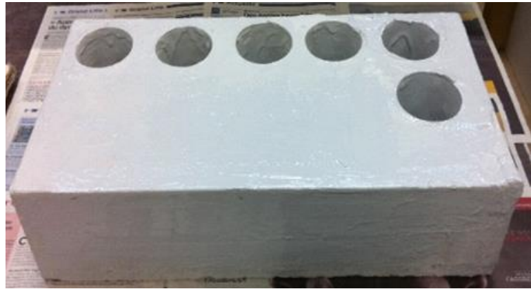
Figure II-7 : [gauche] Une carotte extraite après la première phase de dégradation ; [droite] la dalle carottée avec la réimperméabilisation de chaque zone carottée
