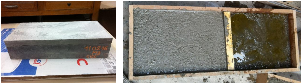
Figure III-3 : [gauche] Cinquième dalle de la série 1, composée d'une dalle de 3 cm d'épaisseur et une dalle de 9cm d'épaisseur, superposée ; [Droite] dalle de la série 2 : mise en place de l'interface huilée
