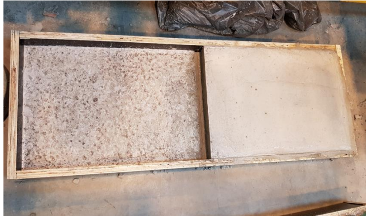
Figure III-6 : Photo de la deuxième dalle de la figure III-5 : reprise de bétonnage à 3 cm de profondeur par rapport à la surface libre
