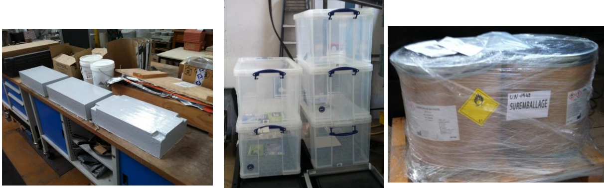
Figure II-5 : [gauche] 3 dalles de béton recouvertes de résines imperméabilisantes sur toutes les surfaces libres (sur la photo) ; [milieu] bacs de rétention utilisés ; [droite] contenants du nitrate d'ammonium pur
