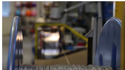
(c) Le câble métallique nouvellement créé est enroulé sur un touret.
