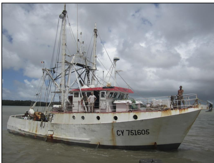
Figure 7 : Le crevettier Miss Sinnamary, qui a été utilisé pour les campagnes scientifiques STUDY II de 2016 et 2017. Les chalutiers floridiens utilisés en Guyane possèdent deux tangons (bras métalliques, ici repliés en position haute).
