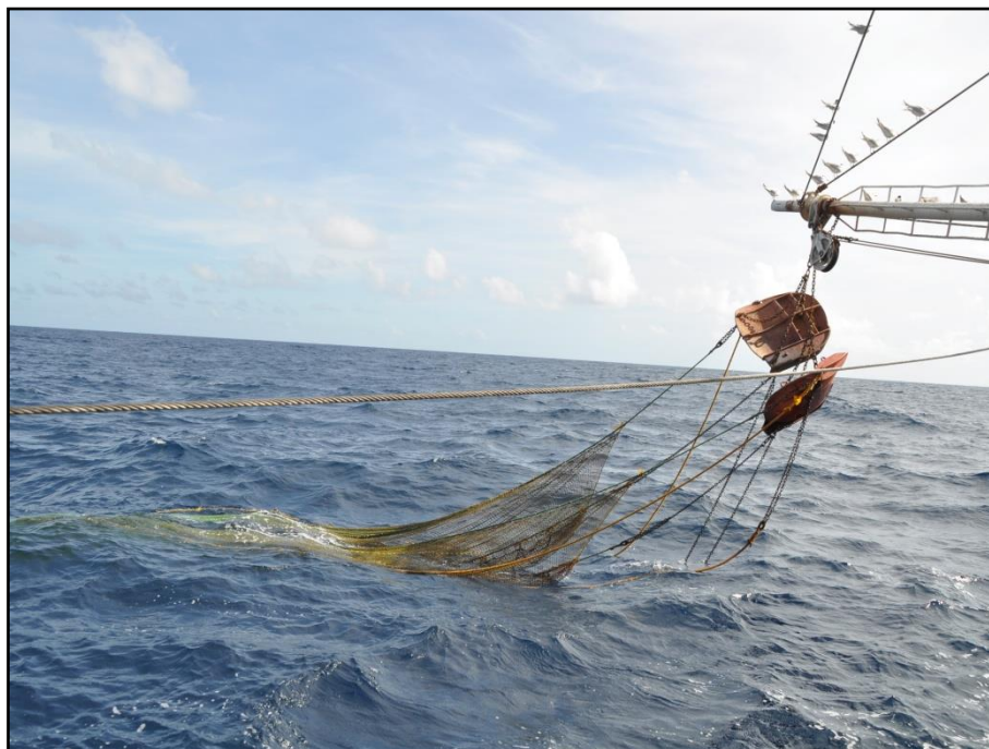
Figure 8 : Chaque tangon (ici en position dépliée en action) supporte un chalut à son extrémité précédé par deux panneaux métalliques qui, une fois le filet descendu sur le fond et avec l'inertie du navire, vont remettre en suspension les espèces sur leur passage qui seront capturées ensuite dans le chalut.
