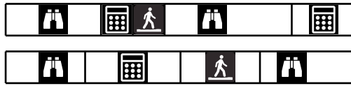
Figure 6.2: Un exemple où pendant que le robot dans la ligne supérieure calcule sa prochaine destination, le robot de la ligne inférieure a bougé : le mouvement du premier robot est décidé en fonction d'informations périmées.
