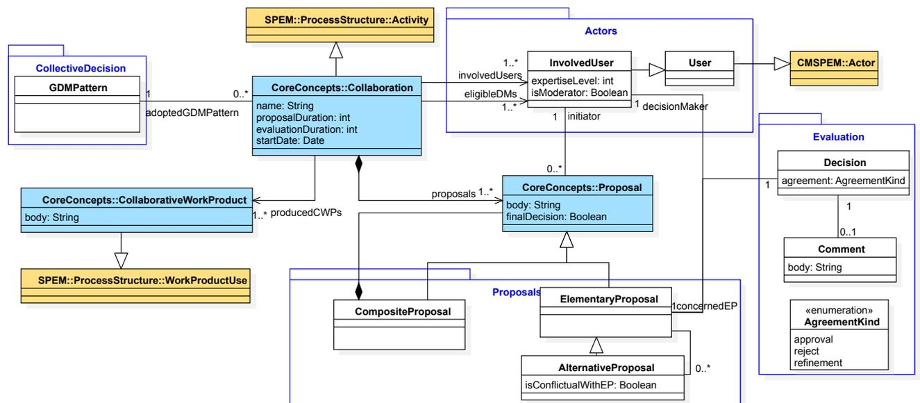
FIGURE 5.2 – Aperçu du méta-modèle de collaboration (MMCollab)
