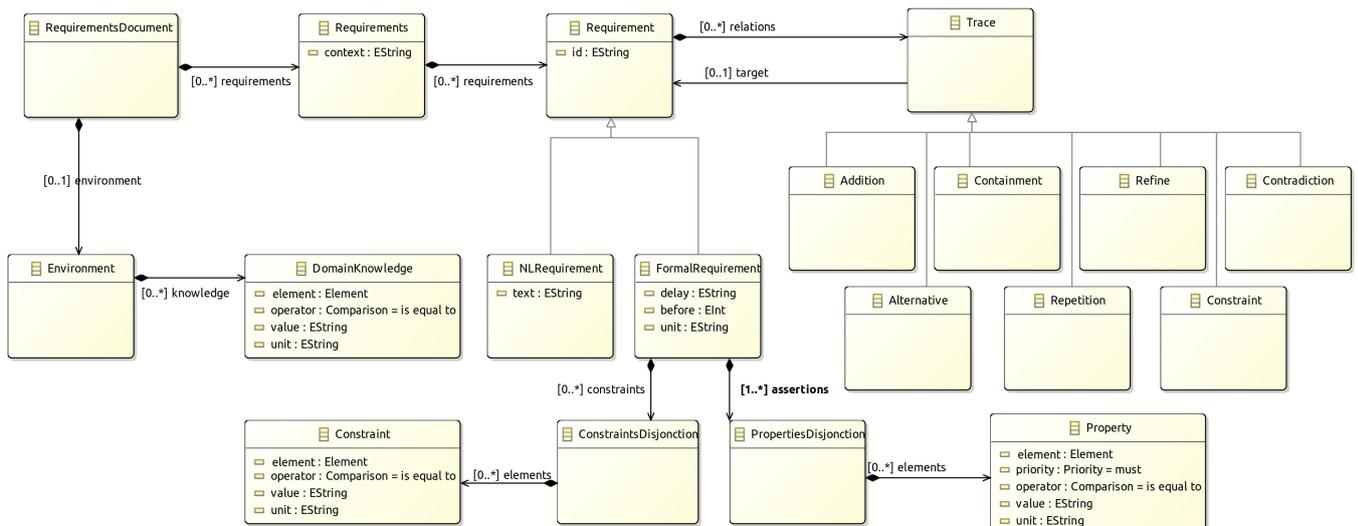
FIGURE 6.2 – Extrait du méta-modèle de RSML
