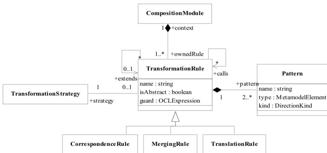
FIGURE 3.10 – Méta-modèle des règles de transformation
