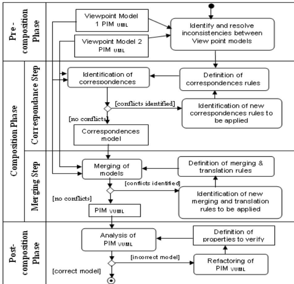
FIGURE 3.6 – Processus de composition dans VUML
