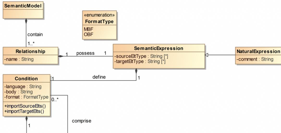
FIGURE 4.16 – DSL pour l'expression sémantique des relations inter-(méta)modèles
