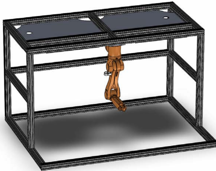
FIGURE 5.19 – Potence du robot. Réalisée d'un ensemble de profilés aluminium 10 cm \times 10 cm, et renforcés par des équerres aux jonctions (non représenté), l'ensemble de la structure pèse près de 500 kg. La structure remplit 2 objectifs : être mécaniquement isolé du reste de l'expérience, et réduire au maximum les vibrations engendrées par le mouvement du robot. Deux grandes plaques en aluminium couvrent la potence, apportant en solidité, et sert aussi de plage d'accueil pour l'ensemble du matériel (ordinateur, contrôleurs, alimentations et câblages).
