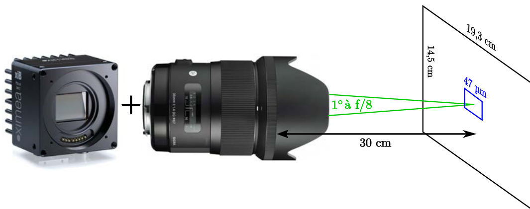
FIGURE 5.12 – Ensemble photographique, constitué d'un objectif (à droite) 35mm de chez Sigma, et d'un boîtier caméra (à gauche) CMOS RGB 12 mégapixels de chez Ximea.
