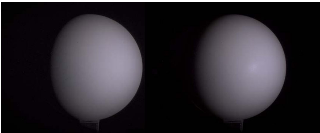
FIGURE 1.7 – Illustration de la différence d'apparence entre deux sphères identiques, dans les mêmes conditions d'éclairage, couvertes d'un matériau différent (Spectralon à gauche, téflon à droite). La géométrie et la "couleur" blanche de ces objets sont les mêmes, on comprend alors qu'il y a une différence plus profonde : l'effet de reflet de la surface, caractérisé par la BRDF.
