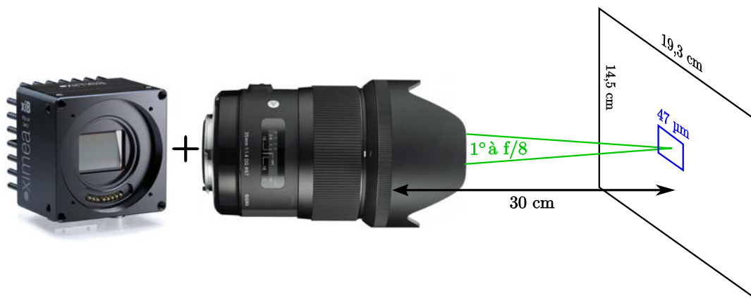
FIGURE 5.12 – Ensemble photographique, constitué d'un objectif (à droite) 35mm de chez Sigma, et d'un boîtier caméra (à gauche) CMOS RGB 12 mégapixels de chez Ximea.
