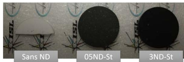
FIGURE V.6 – Photographies des échantillons sans NDs, avec 0,5%<sub>m</sub> et 3%<sub>m</sub> de NDs après frittage sous vide à 1250 °C.
