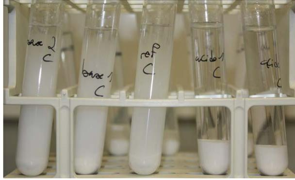
FIGURE II.7 – Exemple de test de stabilité de suspensions de spinelle dans l'éthanol avec ajout de dispersant (Darvan C<sup>®</sup>) après un jour, dans différents milieux (acide et basique).
