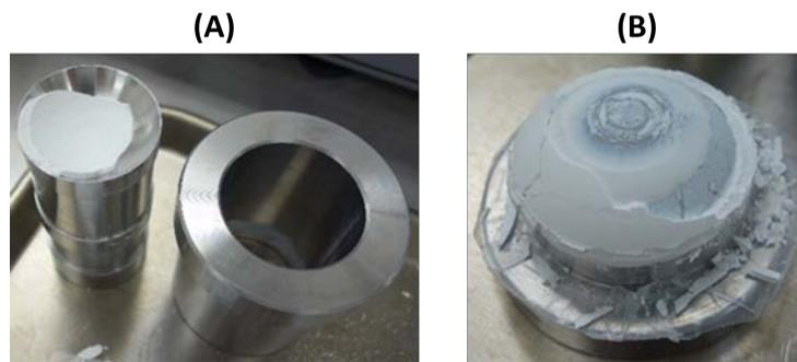
FIGURE VI.7 – Essai de pressage d'un dôme avec l'utilisation d'un Parafilm<sup>®</sup> : le piston supérieur (A) et le piston inférieur (B).
