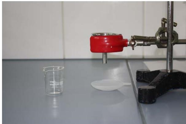
FIGURE II.3 – Montage de mesure d'angle de talus de la poudre.
