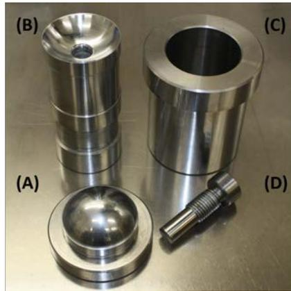
FIGURE VI.6 – Matrice en acier inoxydable pour la mise en forme de dômes par pressage uniaxial : le piston inférieur (A), le piston supérieur (B), le guide (C) et la vis (D).
