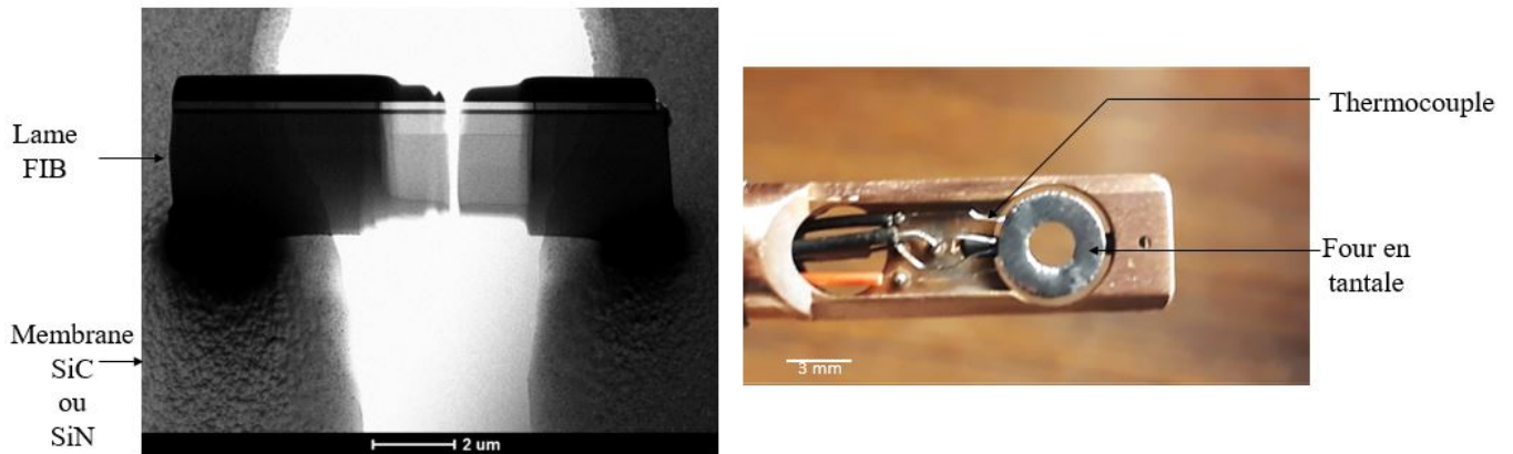
FIGURE 4.21 – Porte objet chauffant Aduro (gauche) et Gatan (droite) utilisés respectivement pour les irradiations de lame FIB et de lame mince.
