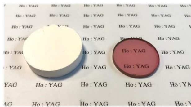
Figure 18. Exemple d'échantillon cru de YAG:Ho puis dense après traitement thermique de frittage.
