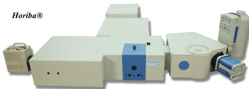
Figure 86. Dispositif de photoluminescence utilisé pour l'obtention des spectres.
