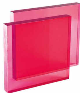
Figure 6. Verre laser commercial de phosphate dopé néodyme de quelques dizaines de cm de cotés et quelques centimètres d'épaisseur [19].
