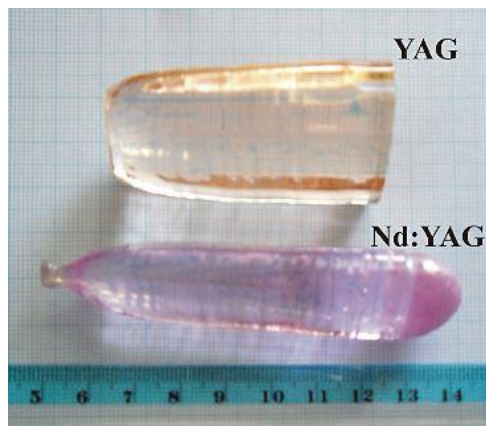
Figure 8. Monocristaux de YAG et Nd:YAG obtenus par la méthode Czochralski [23].
