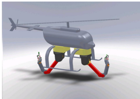
FIGURE 2.19 – Prototype de deux manipulateurs à 4-DDL montés sur un hélicoptère.
