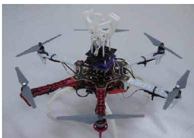
(A) Outil de saisie fixé sous le multirotor Exemple de récolte de fruits.
