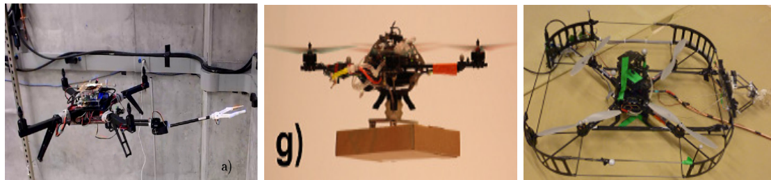
(A) Manipulateur attaché avec un système de vision embarqué. (B) Manipulateur aérien avec un préhenseur de ventouse auto-obturante. (C) Quadrotor avec manipulateur planaire connecté avec une liaison prismatique virtuelle.
