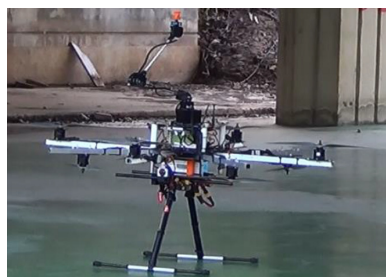
(B) Bras manipulateurs montés sur un Quadrotor pour inspecter un pont.
