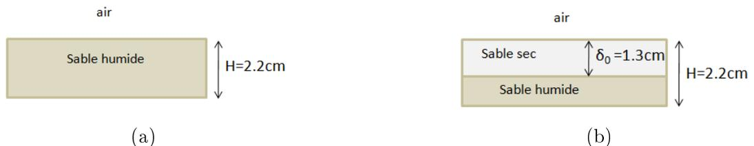
FIGURE C.1 – Illustration des mesures expérimentales de séchage : mesure (a)  $S01$  et (b)  $S02$ .
