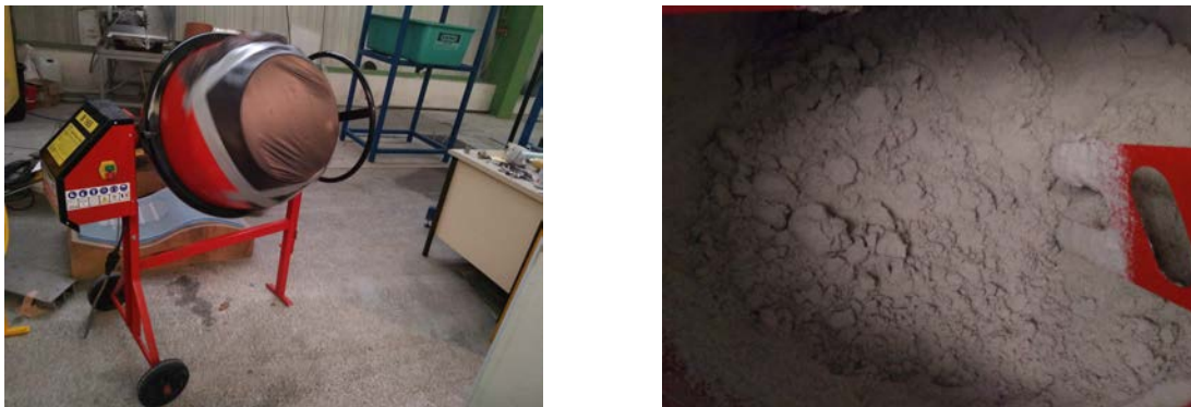
FIGURE 4.1 – Mélange à la bétonnière : (a) après avoir ajouté l'eau au sable, la bétonnière est couverte puis mise en fonctionnement pendant une heure. (b) Photo du sable humide après le mélange.
