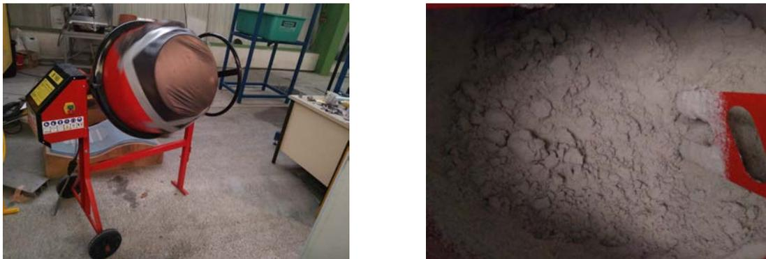
FIGURE 4.1 – Mélange à la bétonnière : (a) après avoir ajouté l'eau au sable, la bétonnière est couverte puis mise en fonctionnement pendant une heure. (b) Photo du sable humide après le mélange.
