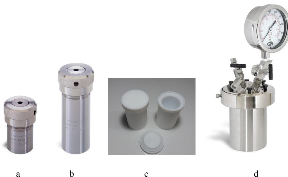
Figure 3.9 : Autoclaves utilisés pour les différentes synthèses a) Parr inox 23 mL, b) Parr inox 45 mL, c) chemises en téflon pour les autoclaves Parr de 23 et 46 mL, d) réacteur Parr en Hastelloy ® de 300 mL
