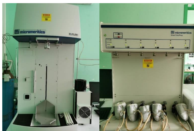
Figure 2.3 : Instrument d'adsorption/désorption d'azote 3Flex MICROMERITICS (gauche) et station de dégazage Smart VacPrep MICROMERITICS (droite)
