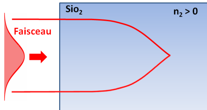
Figure 1.4 : Représentation de l'effet Kerr optique, conduisant à l'autofocalisation du faisceau dans le matériau.
