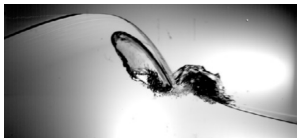
Figure 2.11. – Photographie du déferlement plongeant observé expérimentalement par P. Lubin et al en 2019 [52].
