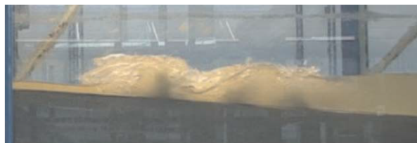
(c) Expérience en laboratoire du déferlement de vague sur une plage. L'image provient de l'article de B. M. Sumer et al [24].
