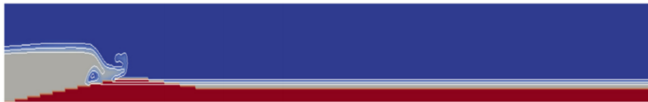
(c) Simulation numérique du déferlement d'une vague sur une récif. L'image provient de l'article de M. Kazolea et al [38].
