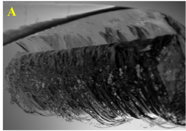
(b) Expérience en laboratoire d'un déferlement plongeant. Des filaments d'air sont visibles autour du rouleau. L'image provient de l'article de P. Lubin et al [52].
