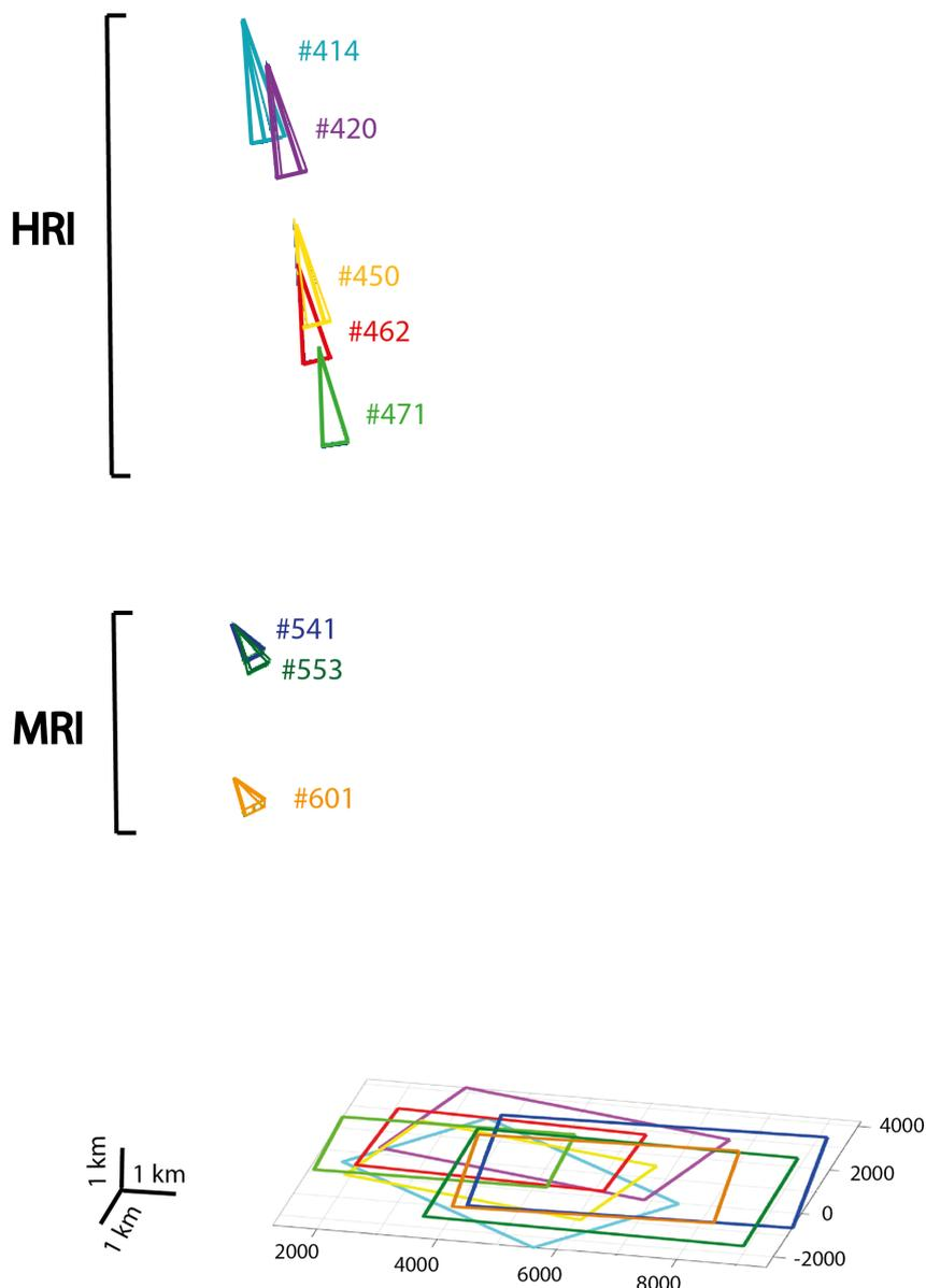
FIGURE III.12. Position et orientation des caméras HRI et MRI, extraites des SPICE kernels, au moment de la prise de vue des huit images sélectionnées (ESA SPICE Service, 2019). On voit également les empreintes des images au sol. Les distances focales sont multipliées par 300 et les coordonnées exprimées en mètre dans un repère tangent local.
