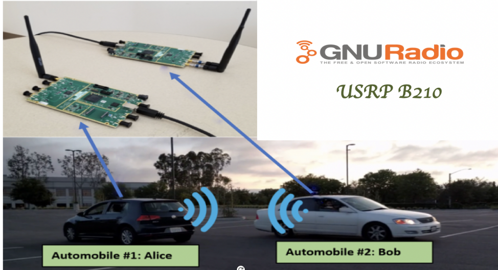
FIGURE 5.4: Configuration expérimentale avec les cartes Ettus B210 embarquées dans les véhicules.
