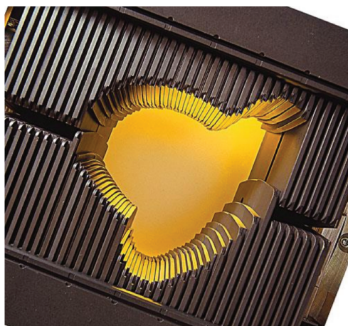
FIGURE 1.22: Collimateur multilames dont la forme est adaptée à une tumeur. Tiré de la Réf. [78].
