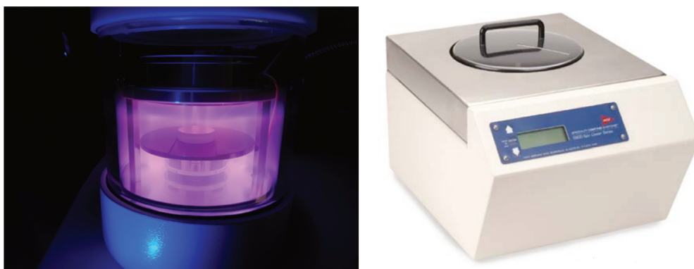
FIGURE 3.27: À gauche : photo du Glow Discharge en fonctionnement utilisé pour le nettoyage des miroirs. On peut voir l'un des miroirs de la cavité disposé au centre de l'appareil. À droite : photo du Spin coater , le miroir est placé sur un support tournant sous la cloche en plastique.
