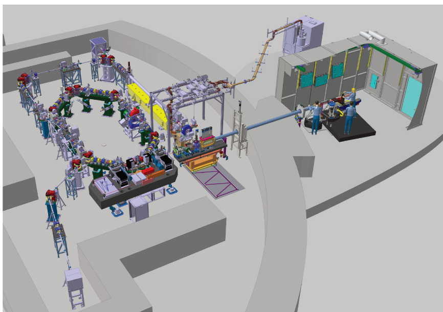
FIGURE 1.10: Vue CAO (Conception Assistée par Ordinateur) de l'ensemble de ThomX.
