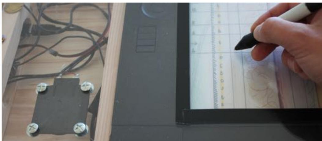
**Figure 4.19.:** Frettage virtuel par retour vibro-tactile : le transducteur tactile (en bas à gauche) émet une impulsion à chaque fois que le stylet franchit une frontière virtuelle (matérialisées par les lignes noires sur le calque).
