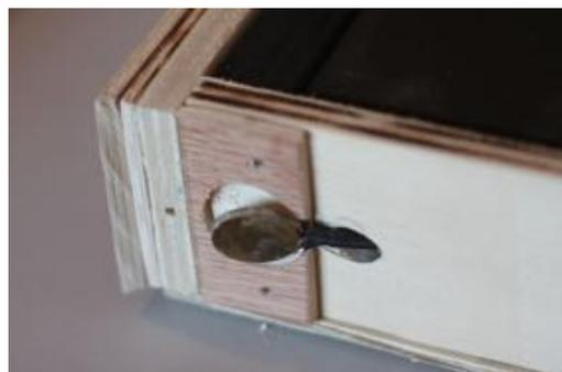
**Figure 4.31.:** Transducteur piezo pseudo-symétrique dans le côté du châssis sur le Xypre v2 (plaque extérieure démontée).
