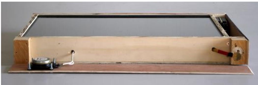
Figure 4.34.: Liaison acoustique entre piezo et haut-parleur tactile sur le Xypre.
