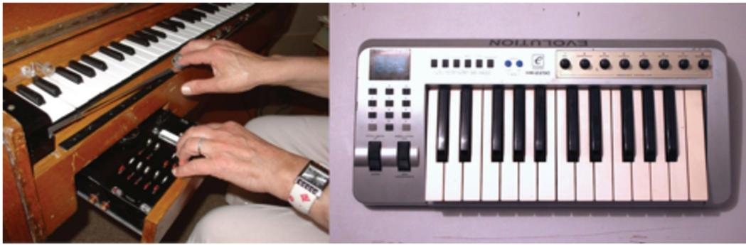
**Figure 4.13.** Un exemple de l'influence de l'agencement des capteurs sur leur usage musical : à gauche l'Onde Martenot : slider linéaire pour le contrôle de hauteur (avec la bague) et capteur de pression pour la modulation (d'intensité). À droite, un clavier MIDI : multiples capteurs de pression pour la sélection de la hauteur absolue et potentiomètre pseudo-linéaire pour la modulation (pitch-bend). Photographie de l'Onde Martenot : Wikipedia User :30rKs56MaE
