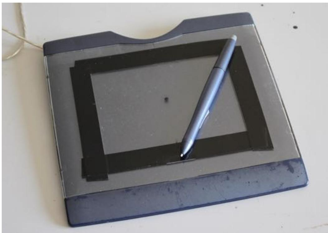
**Figure 4.22.:** Tablette Wacom utilisée à l'origine. Des adhésifs rajoutés en bordure guident la perception haptique, un point central sert de repère visuel.
