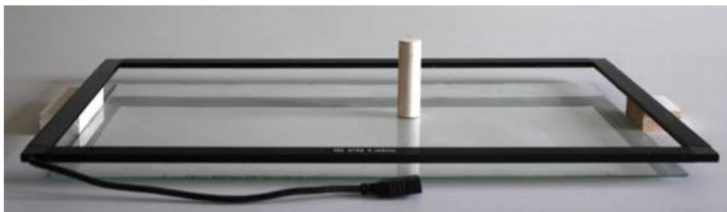
**Figure 4.30.:** Cadre multitouch à technologie infra-rouge (PQ-Labs). La surface de contact en verre est détachable et la captation d'objets quelconques est possible.
