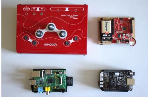
**Figure 2.3.** De haut en bas et de gauche à droite : Eobody, Arduino, Raspberry Pi, Bela.
