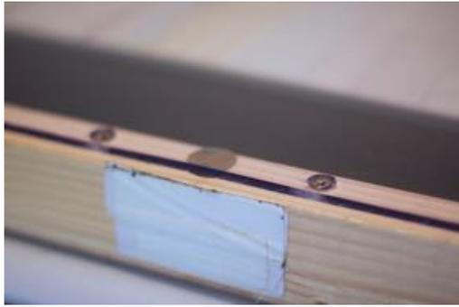
**Figure 4.24.:** Transducteur piezo entre la vitre et le châssis sur le Filigramophone
