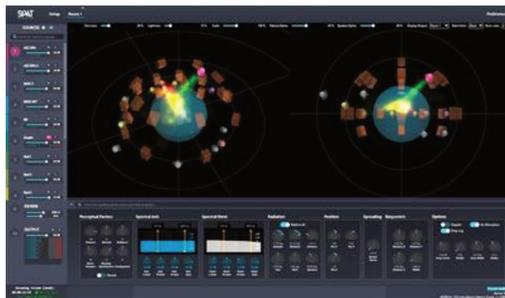
**Figure 6.7.:** L’interface du logiciel “Spat Revolution” de l’IRCAM modélise l’espace de projection acoustique du lieu de concert.
