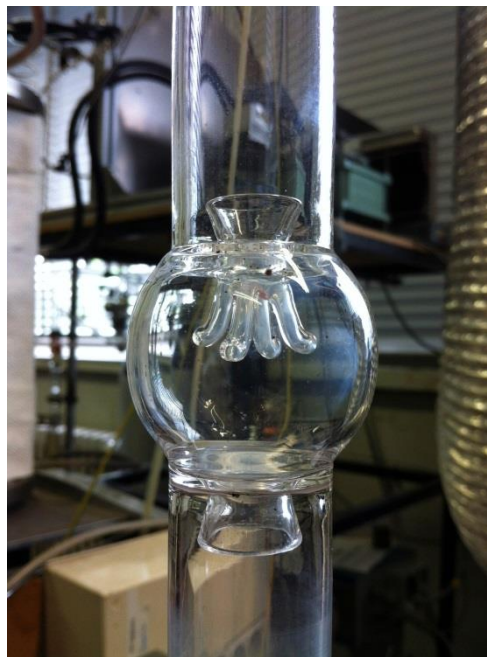
Figure III. 1 : Photo de la chambre réactionnelle du réacteur auto-agité d'Orléans.
