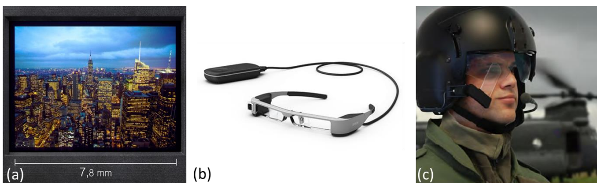
Figure 2 : (a) Microdisplay OLED de la société Microoled, (b) Lunettes de réalité augmentée de la marque EPSON, (c) Casque militaire Q-Sight par la société BAE
