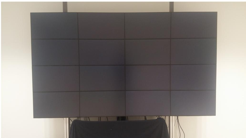
FIGURE 5.9 – Second prototype d'un mur d'écrans de 16 modules d'affichage
