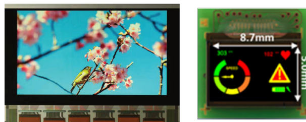
FIGURE 3.4 – Exemple de micro-écrans OLED présentés par [37] et [11]
