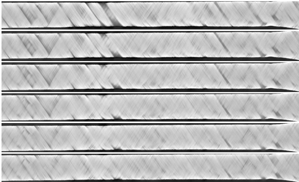
Figure 58: Observation par Tomographie X d'une éprouvette non chargée par un balayage à travers l'épaisseur
