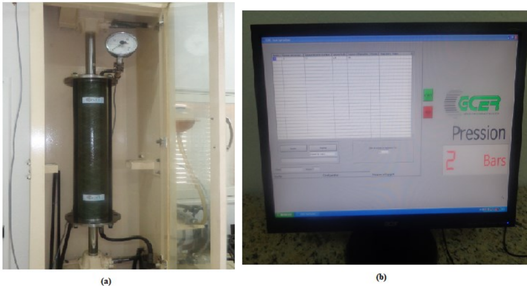
Figure 95: Dispositif expérimental de l'essai de mise sous pression du tube (a) tube maintenu sous pression, (b) affichage de la variation de la pression
