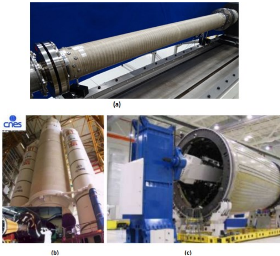
Figure 10: Quelques exemples d'application du procédé d'enroulement filamentaire dans le domaine de l'aéronautique : (a) Arbre de transmission d'un hélicoptère, (b) Structure de fusée, (c) Fuselage
