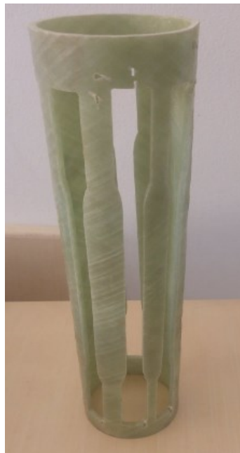
Figure 32 : Tube découpé par jet d'eau pour obtenir des éprouvettes longitudinales
