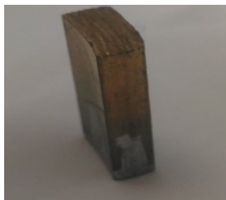
Figure 36: Morceau de l'éprouvette endommagée découpée au niveau de la zone utile, métalisée pour l'observation par MEB
