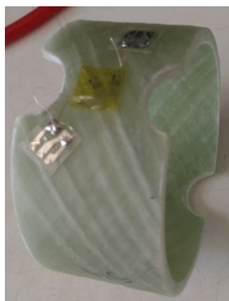
Figure 65: Rosette collée sur l'anneau pour mesurer les déformations dans les deux directions longitudinale et transversale
