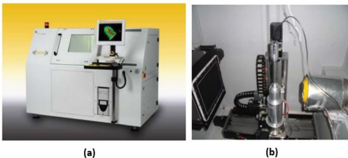
Figure 37: (a) Dispositif de tomographie du laboratoire (Phoenix X-ray), (b) détails du système : une platine de rotation, une source et un détecteur
