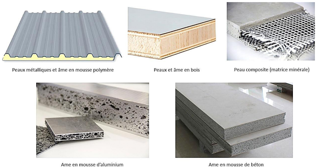
Figure 1.2 Illustration des matériaux constituant les panneaux sandwichs.
