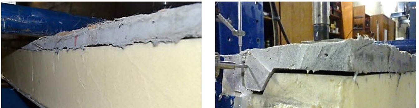
Figure 1.7 Rupture d'un panneau sandwich fléchi, à l'interface entre la peau en composite minéral et l'âme en mousse polyuréthane [13].
