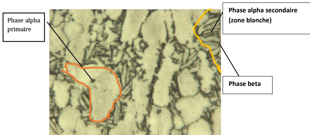
Figure V. 12 Image au microscope optique du Ti6Al4V après attaque chimique pour révéler les zones nodulaires (alpha primaire) et lamellaires (alpha secondaire + beta);
