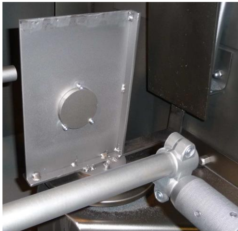
Figure V. 1 Dispositif de grenailage classique pour un disque en Ti-6Al-4V ;
