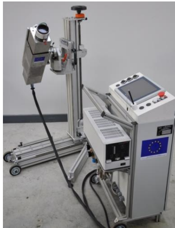
Figure V. 2 Appareil portatif pour grenailage ultrasonore ;
