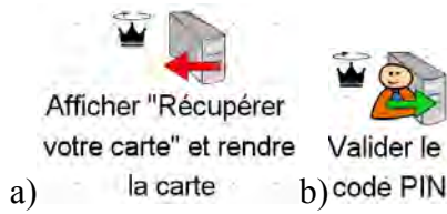
Figure 56. Symbole représentant une transition de contrôle associé à a) une fonction et à b) une tâche
