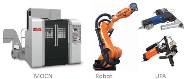
Figure 1-12 : Machines industrielles de perçage (Ladonne, 2016)
