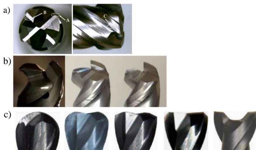
Figure 1-11 : Fraises utilisées par (a) (H. Li et al., 2014) pour le perçage orbital du Ti6Al4V, (b) par (Rey, 2016) pour le perçage d'empilages CFRP/Ti6Al4V et (c) par (Brinksmeier & Fangmann, 2010) pour le perçage d'AA2024-T351 revêtu
