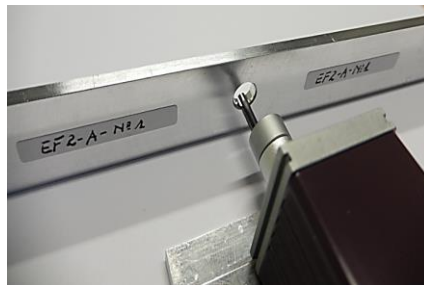
Figure 2-12 : Mesure de la rugosité des trous percés à l'aide d'un rugosimètre mécanique 2D
