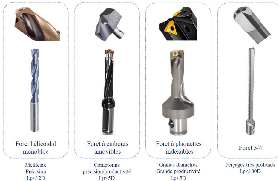
Figure 1-8 : Différents types de forets (Girion, 2017)
