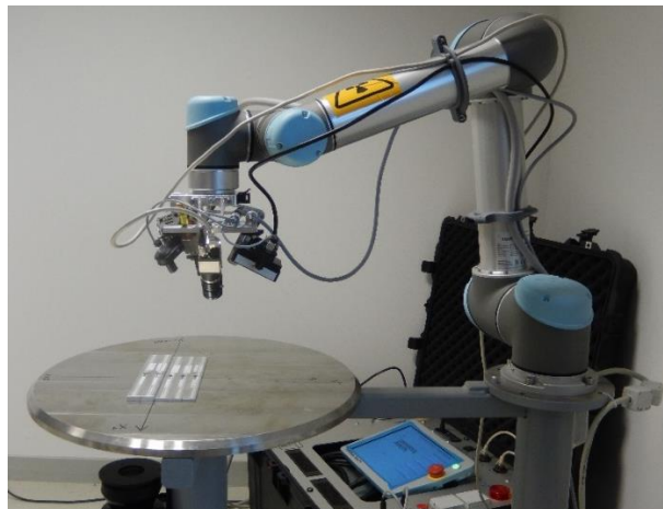
Figure C-2 : Dispositif d'analyse des contraintes résiduelles par DRX
