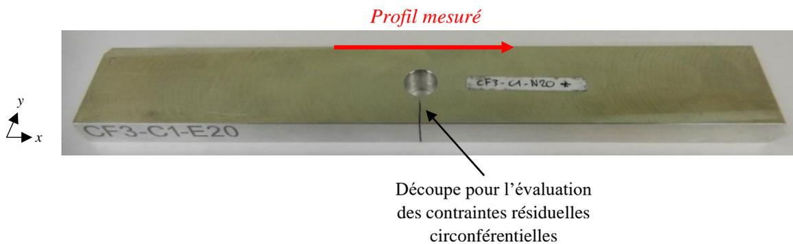
Figure G-1 : Adaptation de la méthode du découpage (splitting method) aux éprouvettes de fatigue étudiées
