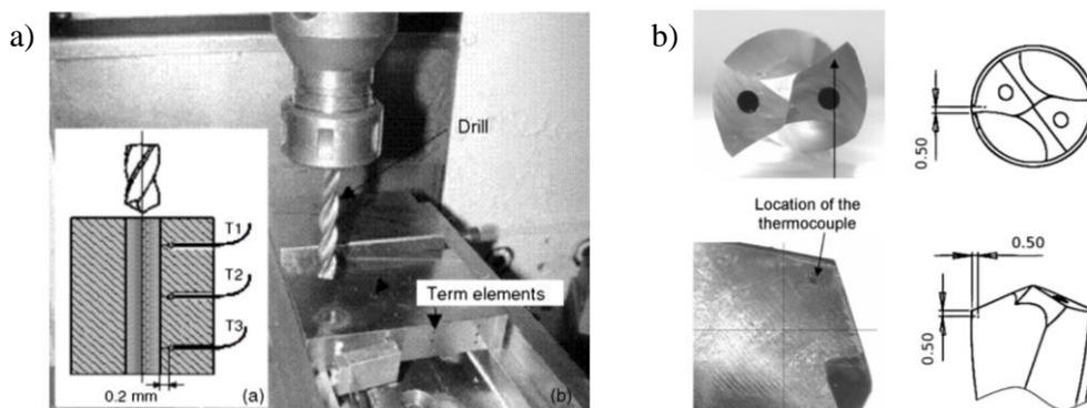
Figure 1-21 : Exemple d'implantation de thermocouples dans la pièce usinée (Zeilmann & Weingaertner, 2006) (a) et dans l'outil (G. Le Coz et al., 2012) (b) pour la mesure de température en perçage
