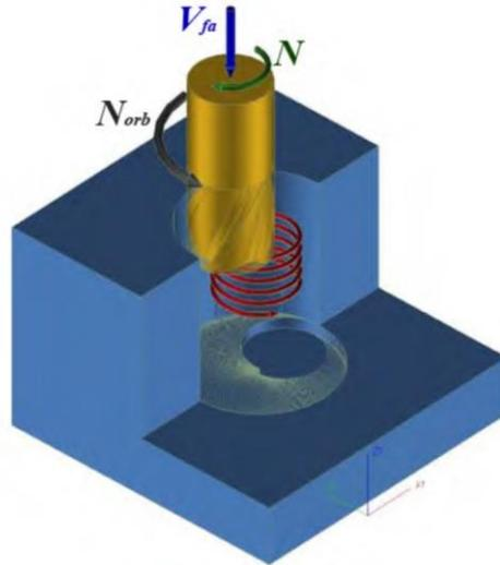
Figure 1-7 : Cinématique du perçage orbital (Rey, 2016)
