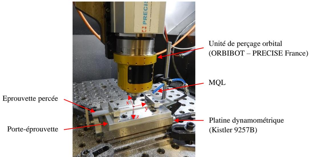
Figure 2-6 : Dispositif expérimental pour la mesure des efforts de coupe au cours du perçage orbital
