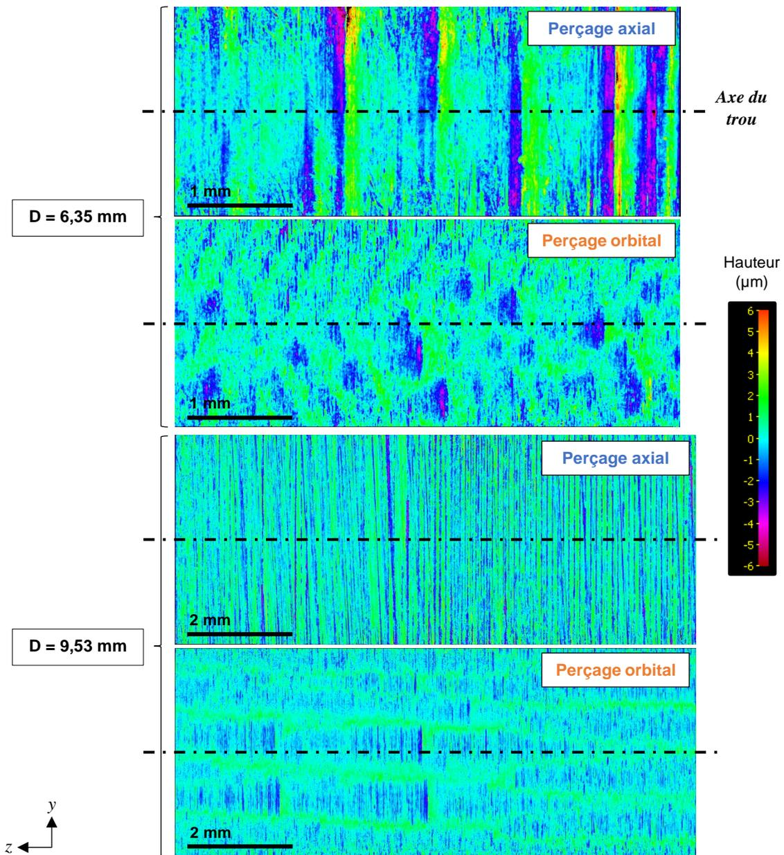
Figure 3-2 : Exemple de cartographies de rugosité obtenues
