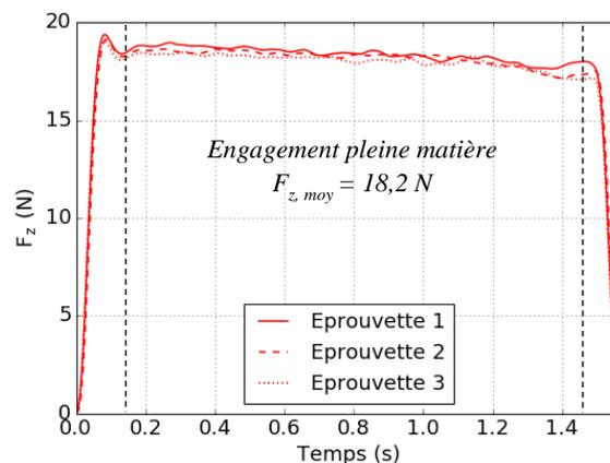
Figure 3-9 : Mesure de l'effort axial au cours du perçage axial de diamètre 9,53 mm avec un avant-trou de diamètre 8,9 mm
