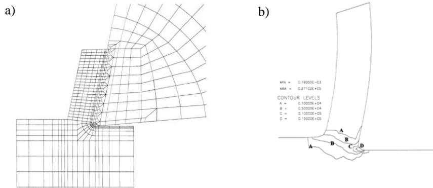
Figure 1-32 : Simulation de coupe orthogonale dans de l'acier avec formulation Eulérienne, géométrie initiale du copeau supposée (a), prédiction de la distribution des vitesses de déformation (b) (Kim et al., 1999)
