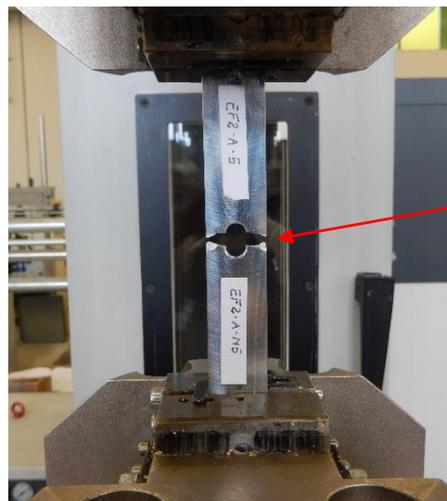
Rupture de l'éprouvette au niveau de sa section nette
