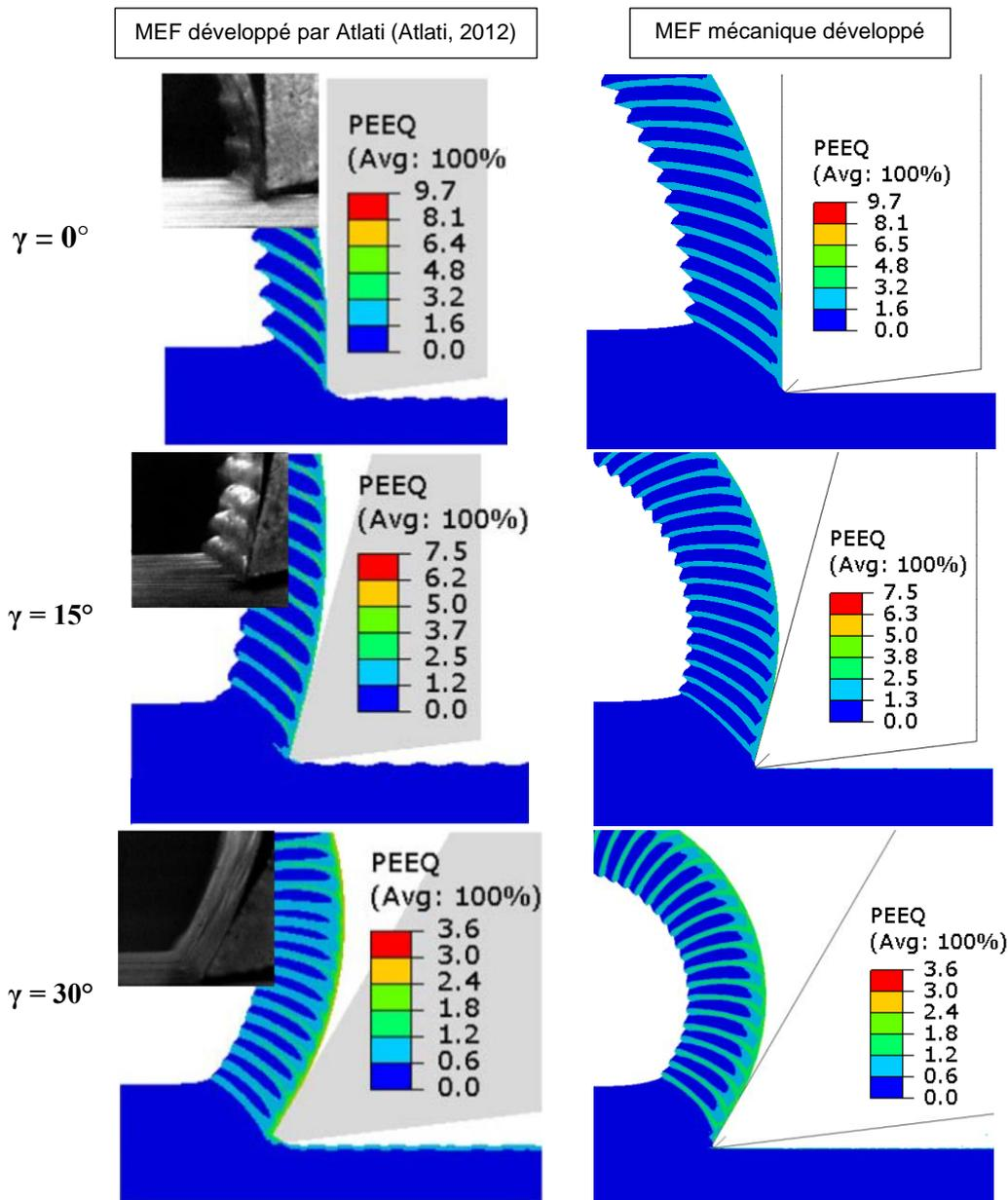
Figure 4-9 : Comparaison de la morphologie et de l'état de déformation plastique équivalente des copeaux obtenus avec le Modèle Eléments Finis (MEF) développé par Atlati (Atlati, 2012) et avec le MEF mécanique développé dans cette étude
