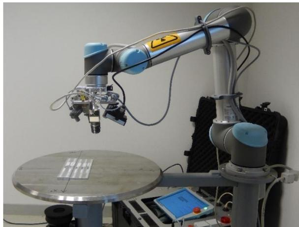
Figure C-2 : Dispositif d'analyse des contraintes résiduelles par DRX
