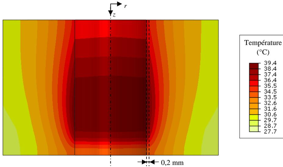
Figure F-6 : Température de la pièce percée à 1,7 s de l'opération de perçage
