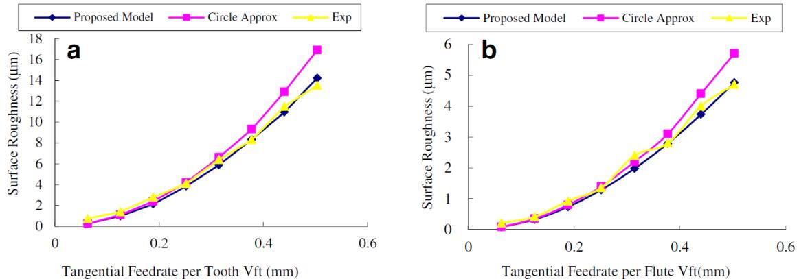
Figure 1-43 : Influence de l'avance tangentielle par dent dans le cas du perçage orbital dans l'alliage d'aluminium 7075-T6 sur la rugosité du trou en termes de  $R_z$  (a) et de  $R_a$  (b) d'après (Z. Li & Liu, 2013)
