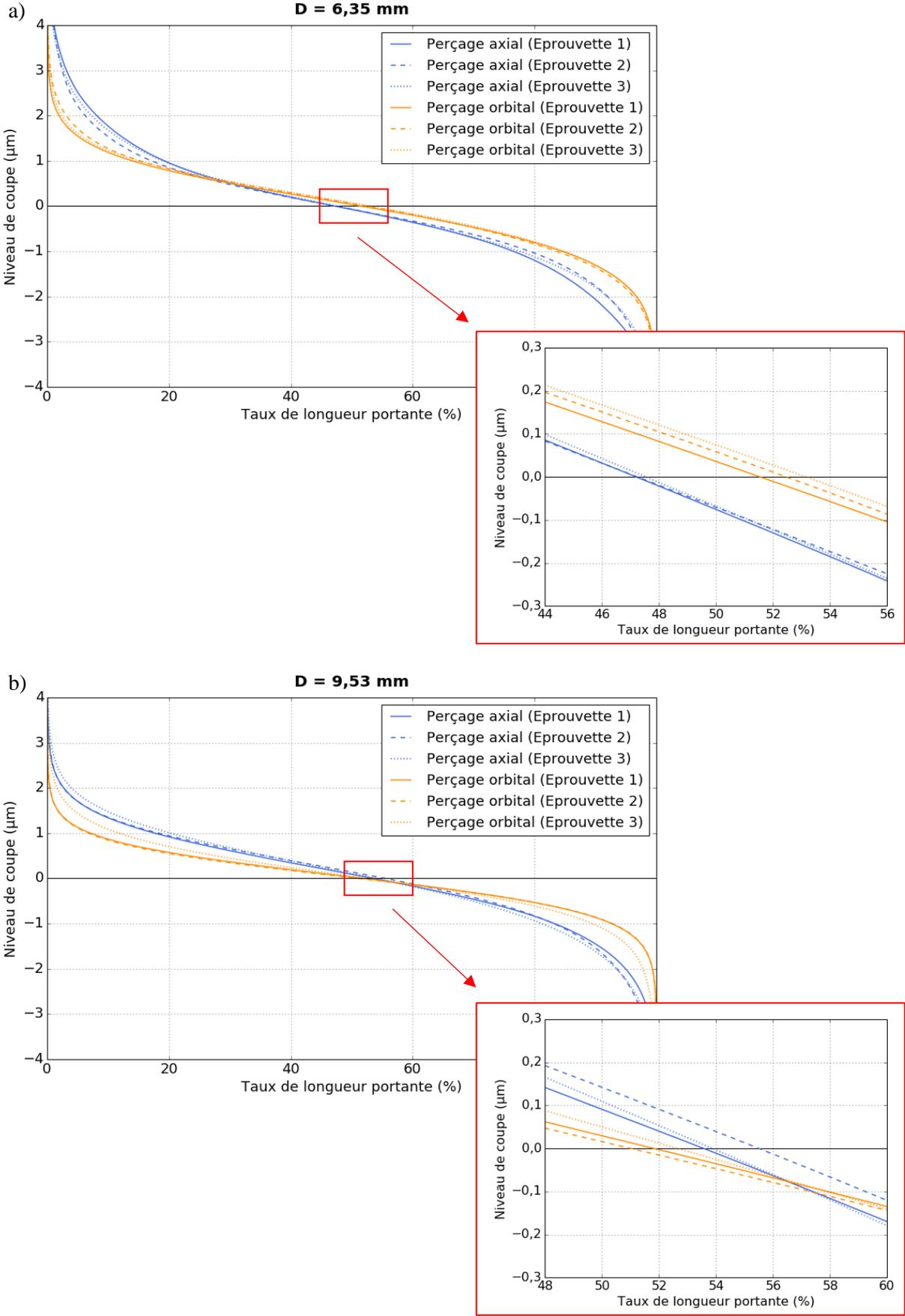
Figure 3-5 : Courbes de portance obtenues pour les diamètres de perçage 6,35 mm (a) et 9,53 mm (b)
