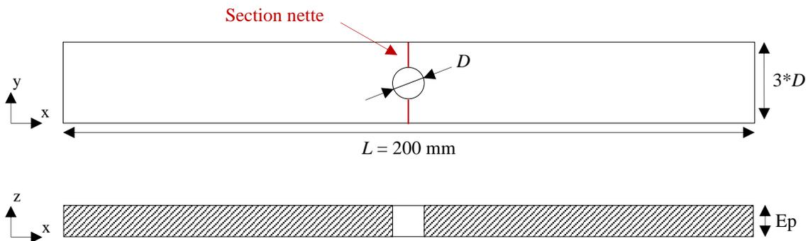
$L$  : longueur de l'éprouvette (mm)
