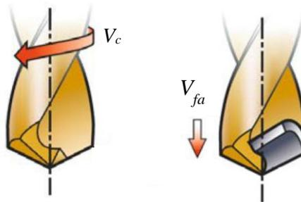
Figure 1-6 : Cinématique du perçage axial (Jrad, 2007)
