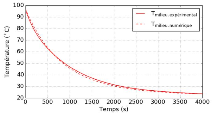
Détermination de  $h$  pour les surfaces en contact avec l'étau
