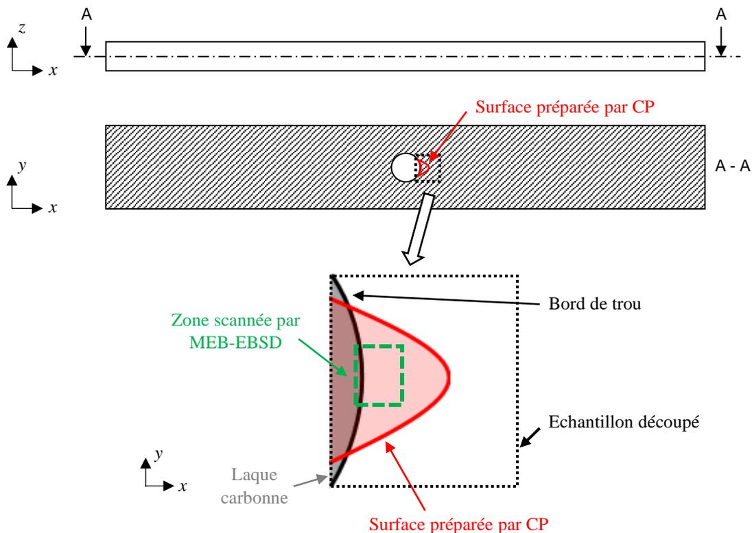
Figure 3-25 : Configuration des analyses MEB-EBSD
