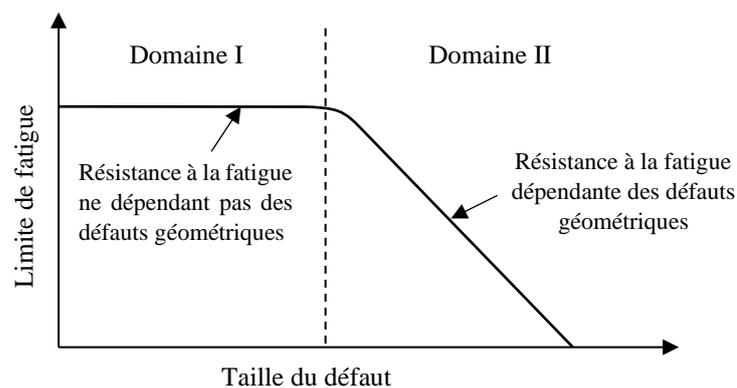
Figure 3-36 : Représentation schématique du diagramme de Kitagawa
