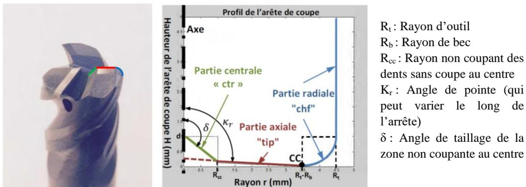
Figure 1-10 : Géométrie des arêtes de coupe d'une fraise pour perçage orbital (Rey, 2016)
