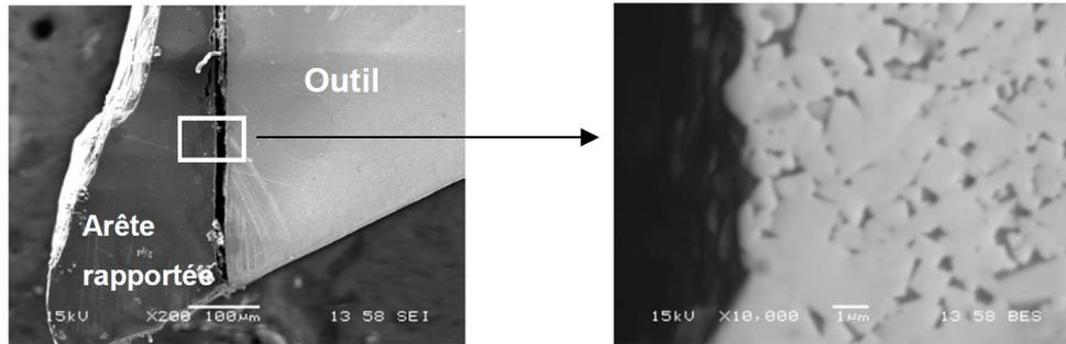
Figure 1-3 : Observation MEB de l'arête rapportée formée à l'issue d'une opération de coupe orthogonale de l'AA2024-T351 avec un outil coupant en carbure de tungstène (List, 2004)
