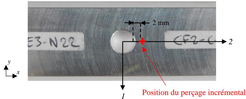
Figure D-1 : Localisation du perçage incrémental effectué
