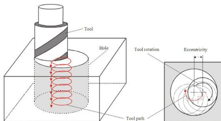
Figure 0-2 : Cinématique du procédé de perçage orbital (Deitert, 2011)
