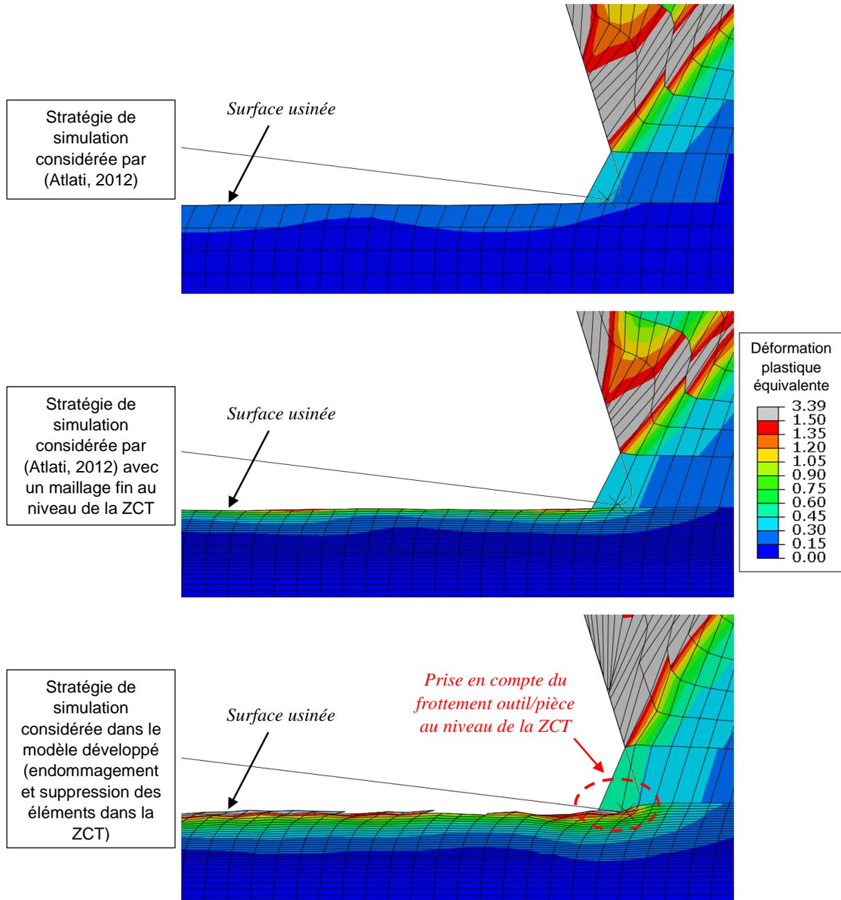
Figure 4-7 : Résultats d'intégrité de surface obtenus avec différentes stratégies de simulation
