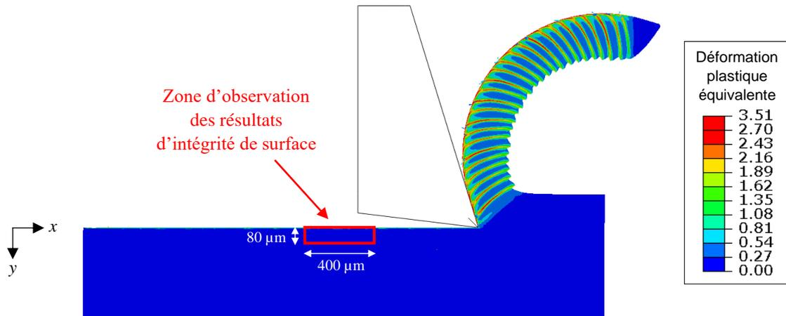
Figure 4-10 : Zone d'observation des résultats d'intégrité de surface
