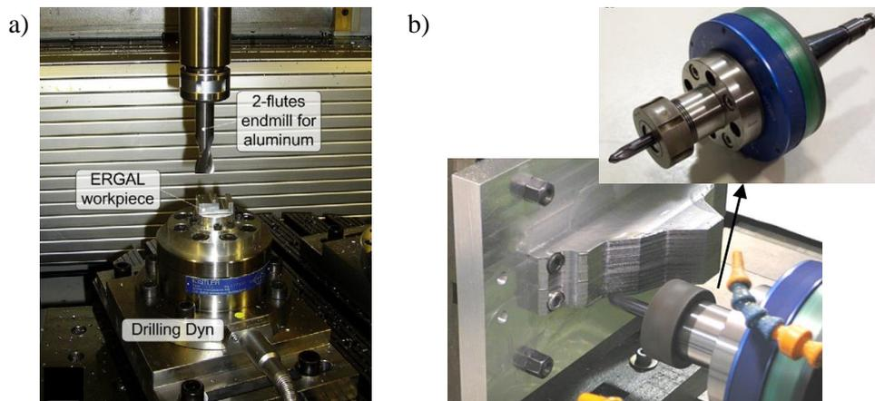
Figure 1-20 : Exemple de dynamomètres statique (Totis et al., 2014) (a) et rotatif (Azeem & Feng, 2013) (b) utilisés pour la mesure d'actions mécanique au cours d'une opération d'usinage
