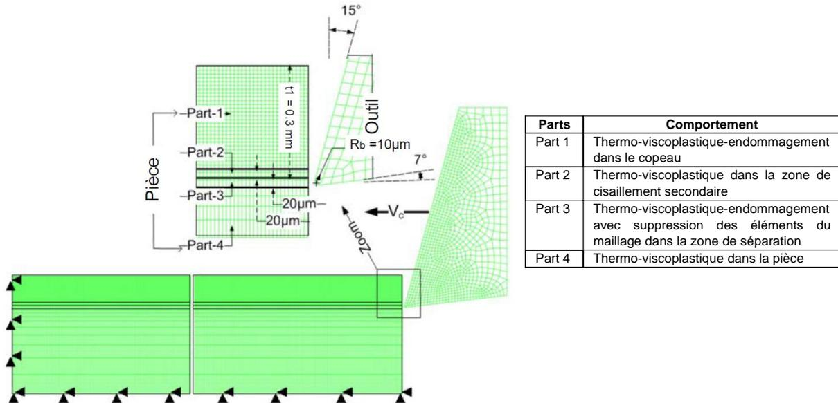
Figure 4-4 : Stratégie de simulation utilisée par Atlati (Atlati, 2012) dans ses travaux sur les échanges thermiques à l'interface outil-copeau appliqués à l'usinage de l'AA2024-T351
