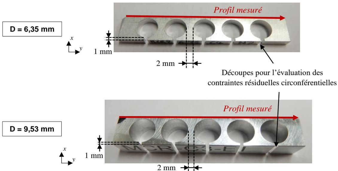
Figure 3-32 : Eprouvettes pour l'analyse de contraintes résiduelles avec la méthode HOCT
