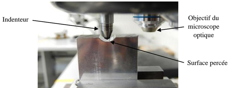
Figure 3-18 : Dispositif d'essais de microdureté Vickers
