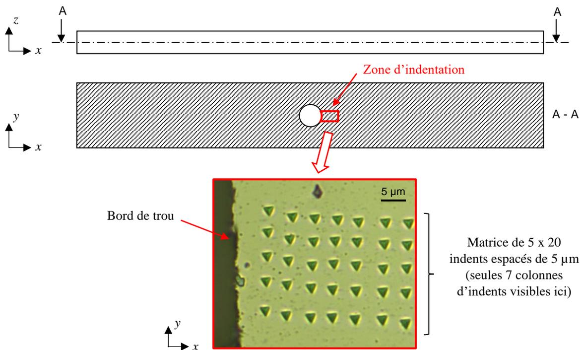
Figure 3-20 : Configuration des essais de nanoindentation
