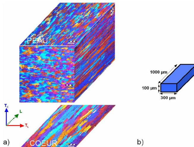
Figure 1-2 : Texture morphologique de l'alliage AA2024-T351 révélée en micrographie optique suite à une oxydation anodique (a) et dimensions caractéristiques d'un grain (b) (Pauze, 2008)
