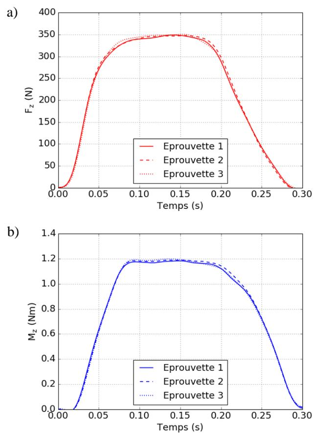
Figure A-1 : Répétabilité des mesures des actions mécaniques en perçage axial :  $F_z$  (a) et  $M_z$  (b)
