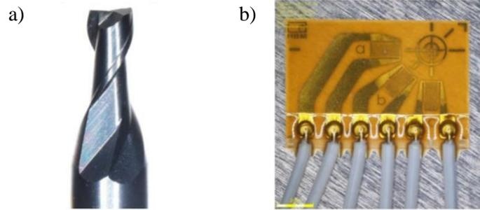
Figure D-3 : Fraise (a) et rosette (b) utilisées pour le perçage incrémental
