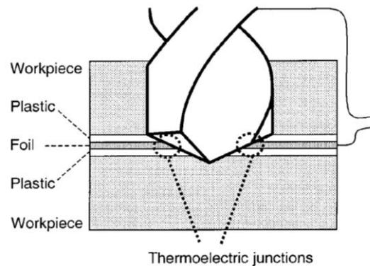
Figure 1-22 : Principe de la technique de mesure de température à l'interface outil/pièce en perçage développée par Bono et Ni (Bono & Ni, 2002b)
