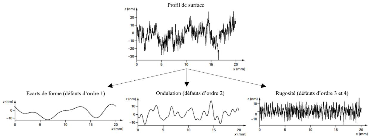
Figure 1-23 : Définition des ordres de défauts géométriques (Bouchareine, 1999)
