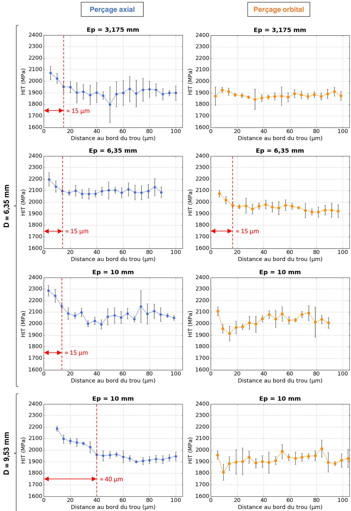
Figure 3-22 : Résultats de nanodureté
