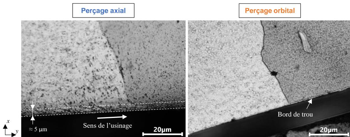
Figure 3-24 : Micrographies optiques : état de la microstructure en bord de trou pour le cas du diamètre de perçage 9,53 mm (grossissement  $\times 500$ )
