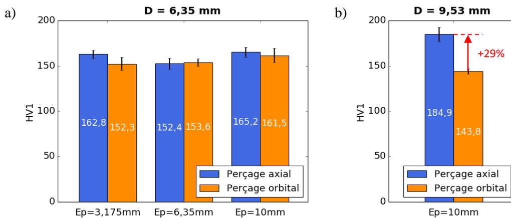
Figure 3-19 : Résultats des mesures de microdureté Vickers
