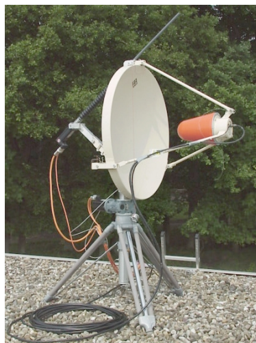
FIGURE 1.23 – Antenne parabolique à diagramme fixe. Un moteur monté sur le trépied permet le suivi mécanique du projectile.
