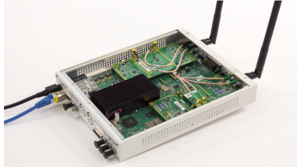
FIGURE 1.33 – USRP X310 pilotée par Matlab via un câble Ethernet, utilisant deux voies sur deux cartes filles.
